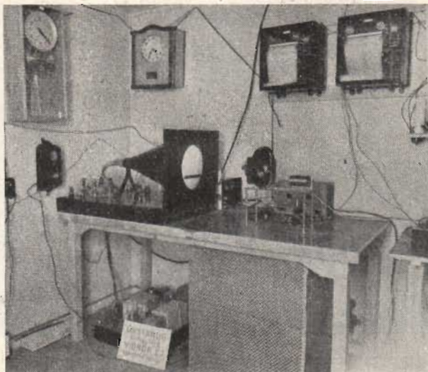
Meteorregistreringen sker med ett 30 cm katodstrålerör samt framför detta en automatisk kamera som tar en bild var 5:te minut. Vänstra klockan anger lokaltiden — varav meteorernas position beror.
