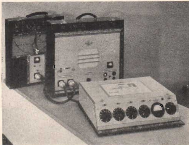
Fig. 5. Förstärkareanläggning med 8 ingångar med pulpet för blandning och kontroll. Förstärkarna är inbyggda i enheterna i bakgrunden.
