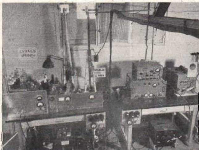
Mätstationen på Mosseberg med fr. v. magnetronsändare för resp. 1, 3 och 10 cm med tillhörande vägledare och elektromagnetiska horn för 10 cm parabolisk reflektor. T. h. en FM-fältsändare för kommunikation med mätvagn.
