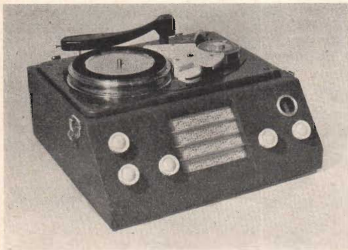
Fig. 4. Trådspelningsaggregat från Siemens-Austria. Anläggningen kan också användas för avspelnning av gramfonskivor. Utstyrningskontrollen är utrustad med indikatoröga. Förstärkare och högtalare är inbyggda. Rörbestyckning EF40, ECC40, EL41, EL41, EZ40, EM1.
