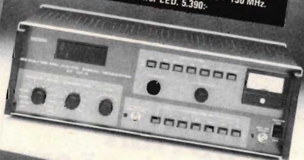
G499. Panoramaoscilloskop. Bildrör 20x12 cm. 2 kanaler. Vertikal 1 mV/cm, horisontal 50 mV/cm. Z-ingång. 5.890:-
