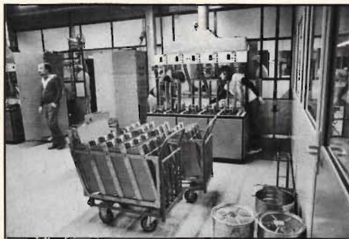
Bakom glasväggarna, skyddskläder och strikt hygienkontroll, framför dem "manuell" utmatning av de nylackerade rå-diskarna, som trimmas för nästa station i fabriken. Fem "linjer" för plattorna.
