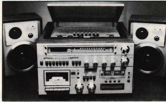
Det spännande ligger under locket till den här "terminalen" från Intersat i USA - där finns satellitmottagningskretsarna. Enheten kan fjärrstyra direktmottagningsantennen och kanalisera ut t ex satellitsänt stereoljud till en videospelare. Två kassettspelare är inbyggda i samma hölje nertill.
