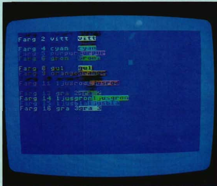
Fig 1. När man slår till apparaten får man blå bakgrund. Texten är skriven i de 16 möjliga färgerna i normalt och inverterat läge. Vi ser att vissa färger är mindre lämpliga mot den här bakgrunden: Rött, blått, brunt och grå 1 är oläsliga. Vill man använda de färgerna bör man programmera in en annan färg som bakgrund. Se fig 2.
