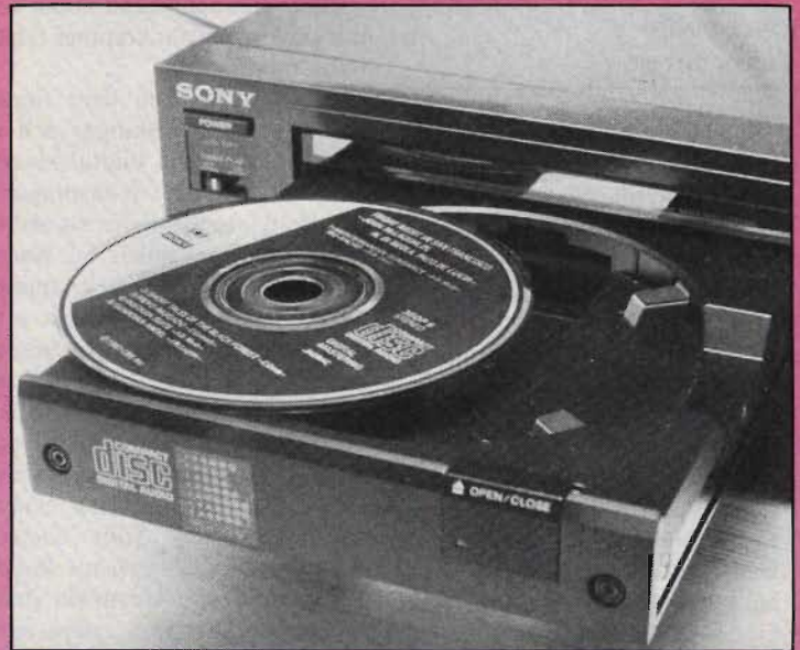
Skivan läggs i en "byrålåda", som dras in i maskinen vid spelning. Observera att den läggs med etiketten uppåt! Inspelningen sitter på andra sidan, och skivan läses alltså underifrån. Om man skulle lägga i den fel så funderar maskinen en stund, och spottar sedan ut skivan igen. Det finns knappast någon möjlighet att göra fel. När väl spelningen pågår ligger alltså skivan inne i maskinen och man kan inte läsa texten, trots att den är vänd uppåt. Men rotationshastigheten är flera hundra varv per minut så det blir nog svårt ändå...
