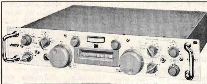
2. Den senare utvecklingen RA 1217, som avlöste RA 217, var utförd för stativförläggning, 19-tum. Mottagaren har börjat bjudas ut på speciellt den nordamerikanska surplusmarknaden.
