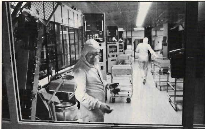
Blick in genom det isolerande glaset till den i nästan heltäckande skyddsdräkter arbetande skiftpersonalen som övervakar de automatiserade, datorstyrda processerna med metallisering, formning och råmaterialtillförsel. Kraven på temperatur, fuktighet, klinisk renhet och sådant som tryck, kylvatten, ånga och strömstyrkor har avsatt komplicerade processövervakningsanläggningar i Polygram-industrin.
