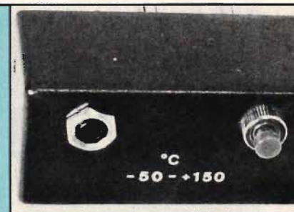
Fig 3: Så här ser den ut, tillsatsen som gör att man kan mäta temperatur med en vanlig digital multimeter. Stiften är placerade så att boxen kan pluggas in direkt. Till kontakten på fronten ansluter vi själva proben. Med en tryckströmbrytare intryckt kontrollerar vi batterispänningen i tillsatsen.
