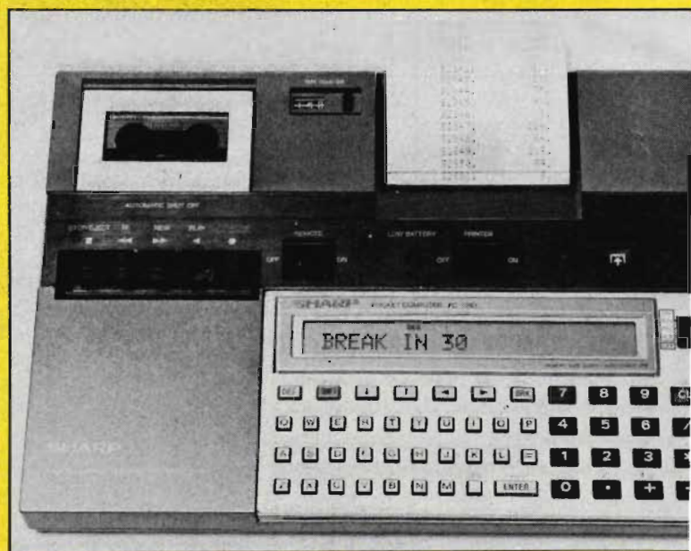
Den lilla datorn går också att bygga ut med en enhet som rymmer kassetminne och skrivare. Kassetminnet använder mikrokassetter, och skrivaren är av termotyp med enklare teckenkvalitet.
