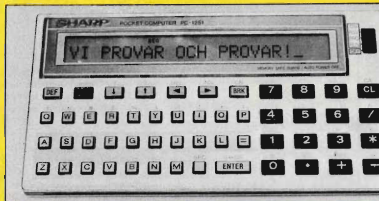
Den lilla datorn går också att bygga ut med en enhet som rymmer kassetminne och skrivare. Kassetminnet använder mikrokassetter, och skrivaren är av termotyp med enklare teckenkvalitet.
