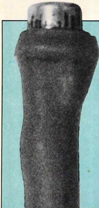
Fig 1: T v. Det här är proben, i stark förstoring, fäst vid en vanlig kvicksilvertermometer för kontroll. Anslutningen till det avkännande elementet är överdragen med en krypslang som håller fukten borta.
