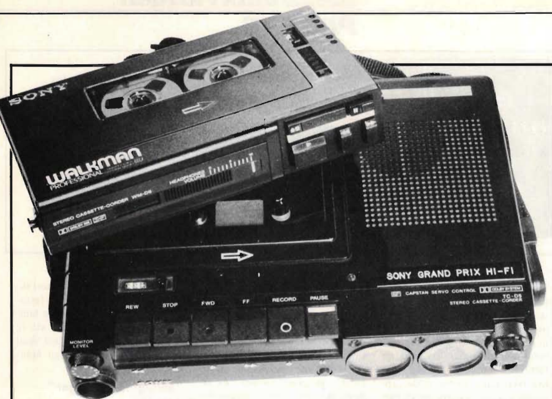
Fig 2. Jämförelsen med föregångaren från Sony, TC-D5, visar storleksrelationen till nyheten WM-D6. Vikten är också motsvarande mindre än hälften. Gör man lite mera kvalifi-
