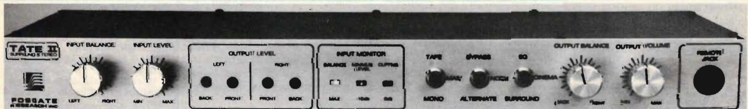
Fosgates Tate II-processor för satellitburet 4-kanalljud. Insignalbalans sköts med ratten längst t v och innivån regleras av den bredvid. Inom det ramade vänstra fältet skruvar man in höger- resp vänsterledens utnivå. Det högra fältet hyser kontrollerna för medhörningskret-
