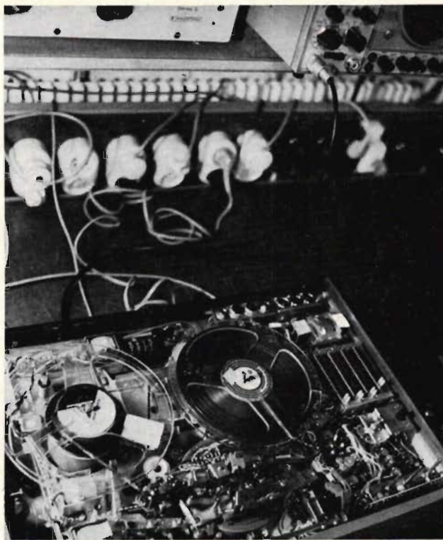
Fig 2. En kompakt uppbyggnad och ett välfyllt innanmäte. Svåråtkomligt: HF-intrimningen. Foto RT.
