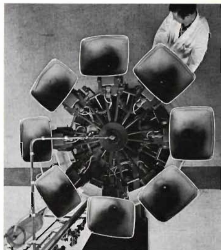
Fig 6. Karusell för automatisk tvättning av bildrörshalsen.
