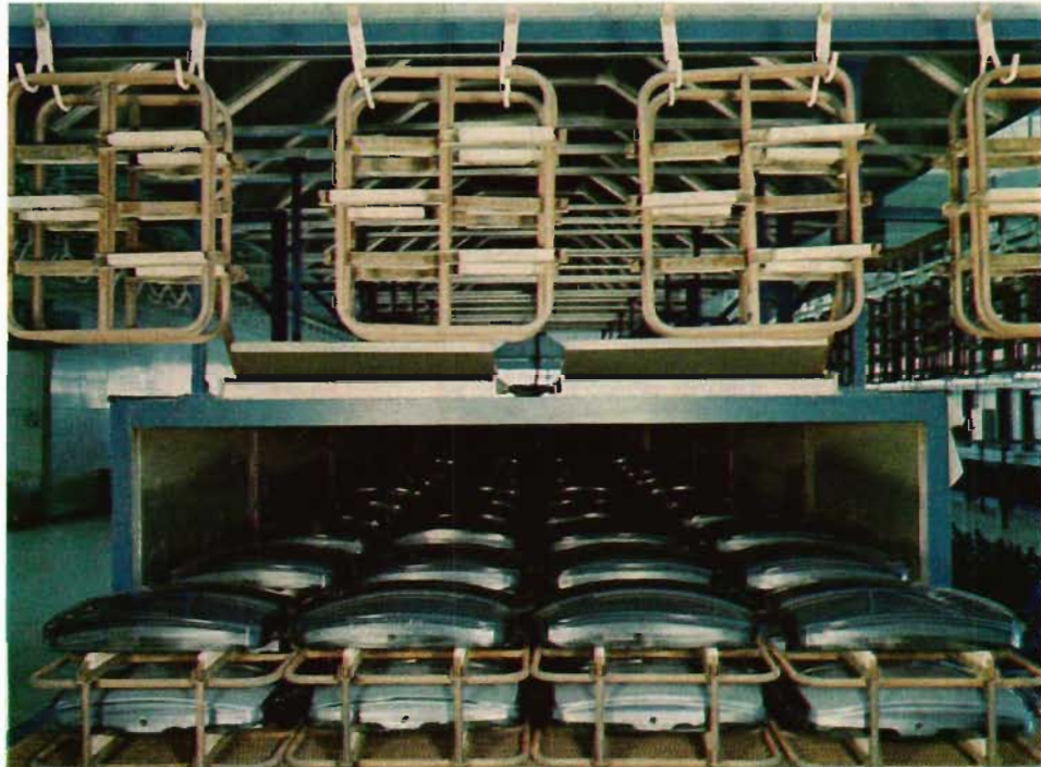
Fig 11. På väg in i ugnen för att stabilisera materialspänningar.
