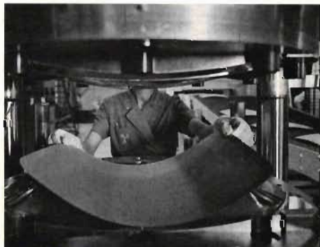
Fig 7. Formpressning av skuggmasken.
