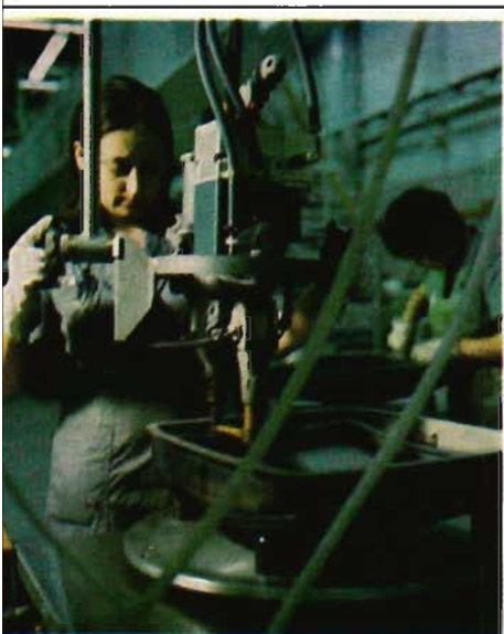
Fig 10. Masken passas samman med bildskärmen och bimetallfjädrarna svetsas fast.
