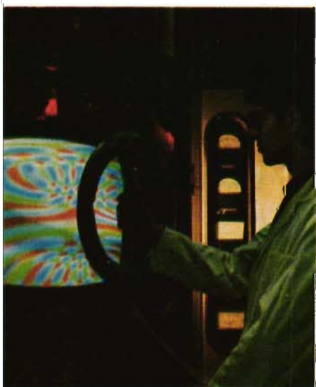
Fig 17. Avmagnetisering under slutkontrollen av bildröret.
