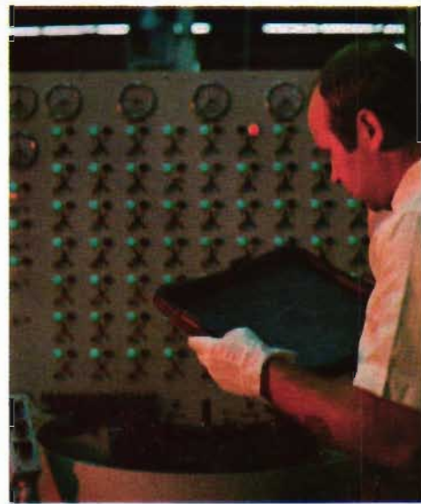
Fig 9. Skuggmaskens form kontrolleras.
