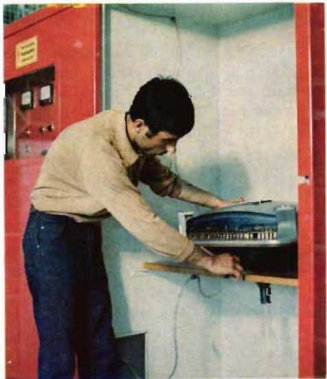
Fig 16. Högspänningskontroll av skarven mellan bildskärm och glaskon.
