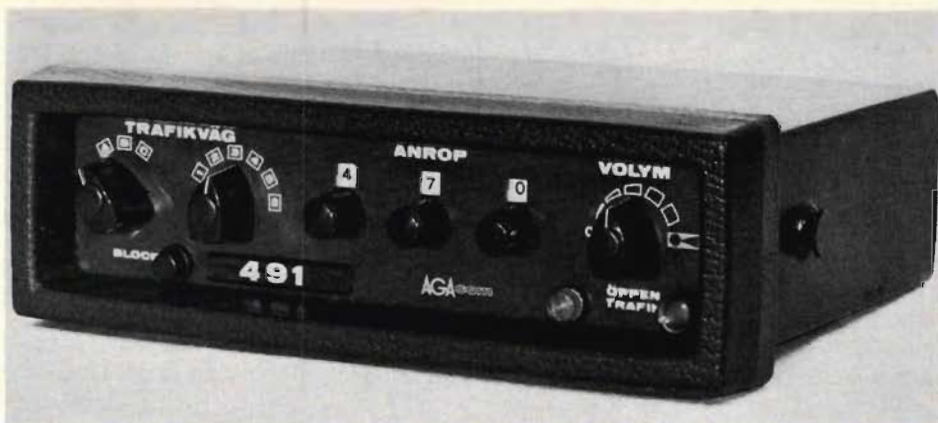
Fig 1. Den mobila manöverenheten i system U-47. Observera den kraftiga ramen av cellplast som inramar manöverpanelen.
