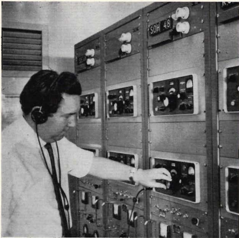
Fig 2. Diversity-utrustning (se även fig 3). för teleprintertrafiken. Linjen, som just kopplas upp på bilden, är för mottagning av Warszawa (SOH48).
