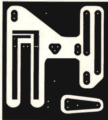
Fig 4. Konverterns kretskort sett från foliesidan. Kortslutningsbyglarnas placering framgår av fig 6. Skala 1:1.
