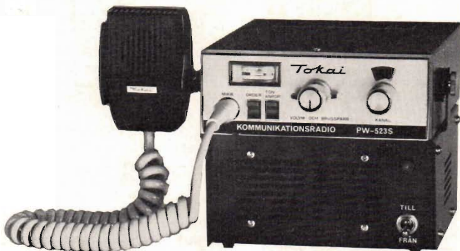
Fig 4. PW-523S som basstation och för stationärt bruk med nätaggregat anslutet under höljet.
