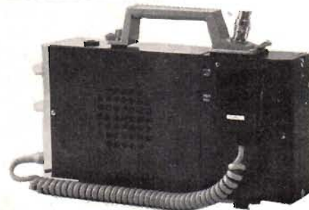
Fig 3. Stationen placerad i batterikassett för bärbart bruk — antenninfästning vid handtagsbygeln.
