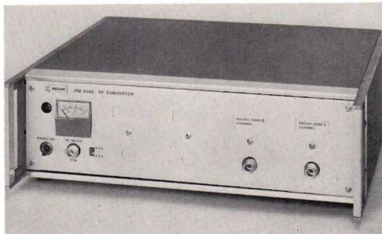
Fig 3. Konverter PM 5596 täcker TV-band I—V och är avsedd att anslutas till modularen PM 5590. Plats finns för fyra kristallstyrda plug in-enheter.
