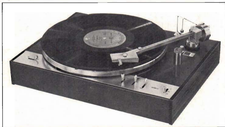
Fig 1. Den nya Eramatic har fotoelektrisk avkänning och en mängd automatfunktioner. Flera originella lösningar finns hos denna franska produkt som bär släktskap med amerikanska AR i vissa avseenden.
