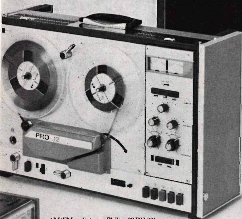
Hi-Fi Stereo studiobandspelare Philips PRO 12 2-spår (kan beställas för 4). 2 hast.: 9,5 och 19 cm/sek. Frekvensområde: 40 – 18 000 Hz – 2,5 dB vid 19 cm/sek; 40 – 15 000 Hz – 2,5 dB vid 9,5 cm/sek. Dynamik: 62 dB vid 19 cm/sek., 60 dB vid 9,5 cm/sek. enl. DIN 45.511. 3 motorer, 3 tonhuvuden. Inbyggd mixer, multiplay och eko. Relämanövrerad. Dim.: 52 × 35 × 24 cm (stående). Ca-pris inkl. moms 3300:–
