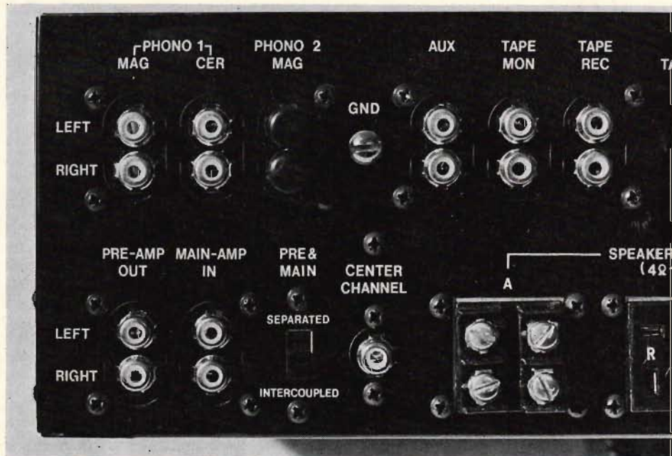
Fig 5. Närbild av ingångarna på bakpanelen, men bilden har främst tillkommit för att visa förekomsten av omkopplaren för anslutning resp separering av för- och slutsteg, "pre & main intercoupling". En bra detalj.
