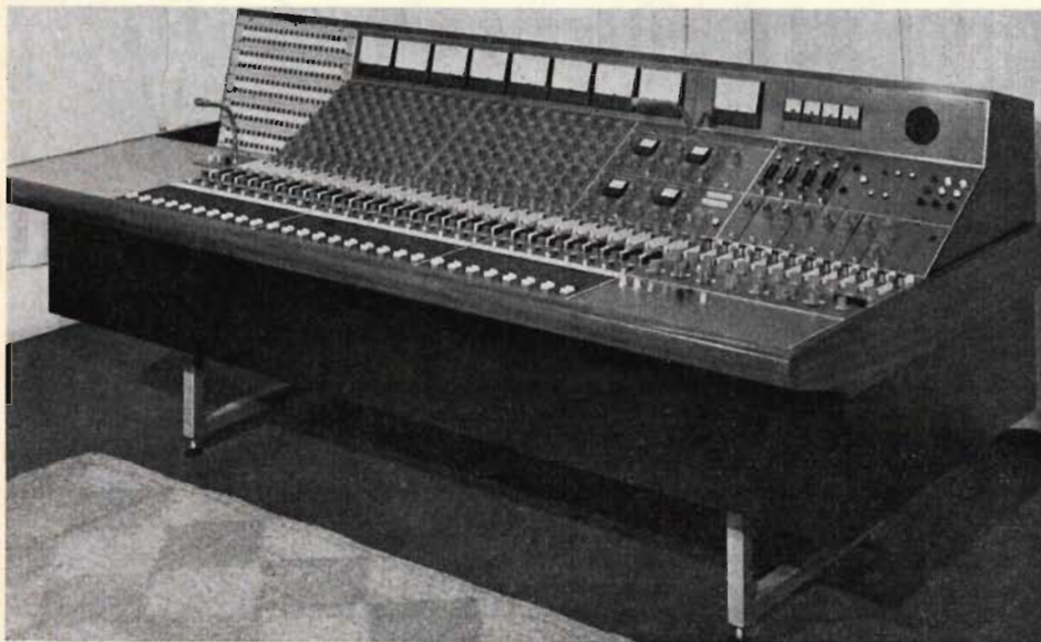
Fig 13. Det här 24-kanaliga bordet återfinns hos ett brittiskt inspelningsföretag och har säkert sina förtjänster, men det torde stå helt klart att ergonomi är något konstruktören aldrig besvärat sig med att studera — förf. avundas inte den tekniker som förväntas betjäna detta gytter av reglage och hålla uppsikt över hela raden utstyrsinstrument och utföra allt annat som blir aktuellt. Ett skräckexempel på oöverskådliga kontrollarrangemang.
