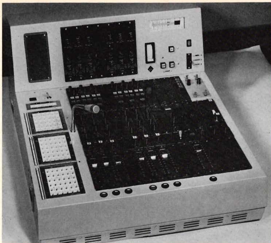
Fig 3. 6-kanaligt kontrollbord för eftersynkroniseringsarbeten (se text).
