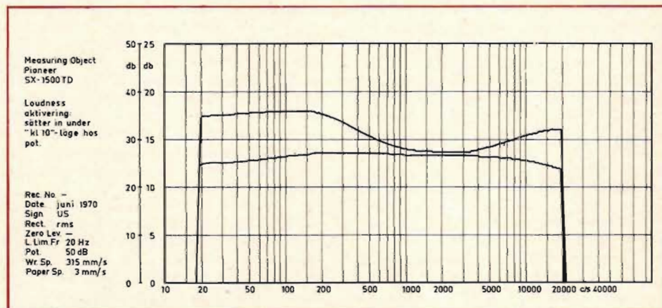
Fig 11. Hörnivåknappens verkan: Aktiveras under "kl 10-läge" hos volymkontrollratten.
