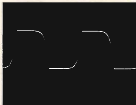
Fig 7. Kantvågssvaret för Pioneer-förstärkaren som helhet. Höger kanal, tonkontrollerna i mekaniskt mittläge, signalen på Auxingången. Effekt 1 W ut över lasten 8 ohm. a) vid 100 Hz, b) vid 1 kHz och c) vid 10 kHz. Som synes inte över sig vacker form i basen (a).
