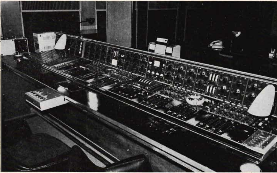
Fig 1 a. Ljudkontrollbord för filmmixning. Bavaria Atelier, München, A-studio. Kontrollbordet används för slutmix.
