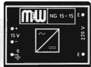
NG 15-15 Spänningsaggregat: 220 V 50 Hz inspänning och \pm 15 V likspänning ut.
