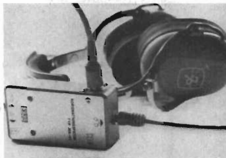
Fig 1. Små, kompakta dimensioner uppvisar Ebabs MA-01 levererat inbyggt i hölje med omkopplare.
