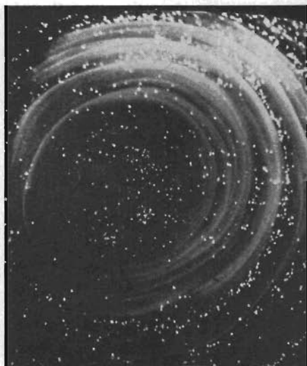
Fig 4. Vid kraftig överstyrning av en kiselvidikon framträder inhomogeniteterna i materialet som koncentriska ringar och vita fläckar.
