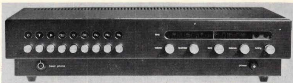
Fig 22. Frontpanelen innehåller en mängd kontroller. Tryckknapparna med symbolerna är från vänster val av gramfoningång, FM-radio, extra ingång och tape monitor. Därefter följer en mono och en stereo omkopplare, rumble-filter och två diskantavskärningsfilter. — Eftersom båda knapparna för diskantavskärningsfiltret kan inkopplas samtidigt, har man ett tre-lägesfilter. Rattarna har följande funktion (med början längst till vänster) volym, loudness, tonbalans, stereobalans och tuning.
