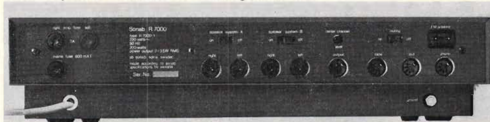
Fig 23. Mittkanalutgång med separat nivåkontroll är en av finesserna som finns på förstärkarens bakpanel.
