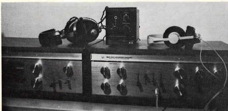
Fig 2. Vid lyssningsprovet har både skivmaterial och radioprogrammet använts i denna enkla "provuppkoppling" — båda hörtelefonerna har varit anslutna samtidigt för snabba A/B-prov över samma förstärkare, vars högtalarutgångar anslutits till Kossaggregatet.
