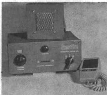
Fig 4. Executive CTZ-10F kunde användas som bas- eller mobilstation, beroende på vilket strömförsörjningsaggregat man valde, eftersom detta var skilt från själva stationen, en trekanalare med kontinuerligt avstämmd mottagare.
