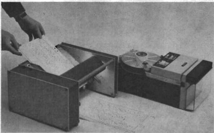
Fig 2. I den optiska läsaren matas elevsvaren in och informationen registreras via remsstansen på hållemsa.
