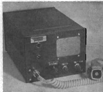
Fig 6. Laser Electronics i Hägersten tillverkade Panophone JG-5, ett gediget arbete som bla hade en mycket lågbrusig mottagare.
