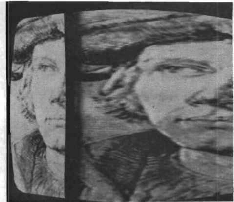
Fig 12. TV-bild uppbyggd av direktbild (tv) och motsvarande bild sedan den fördröjts i ett analogt skiftregister (th).
