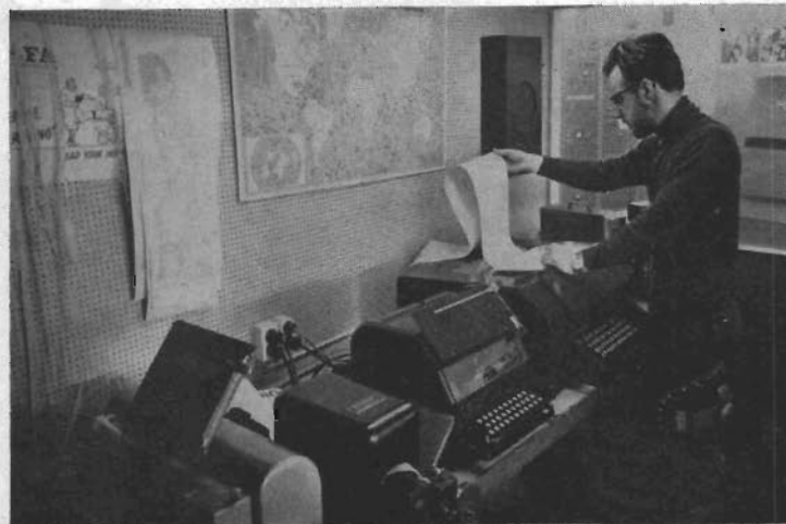
Fig 1. Gamla och nya grejer samsas om det trånga utrymmet i SSA:s klubbstation på Tekniska Museet. På bilden t v stämmer stationsföreståndaren och tillika bulleuppläsaren SMØDZL av det nyförvärvade Drake-slutsteget och t h kollas en RTTY-remsa som Creed-maskinen just spottat fram.
