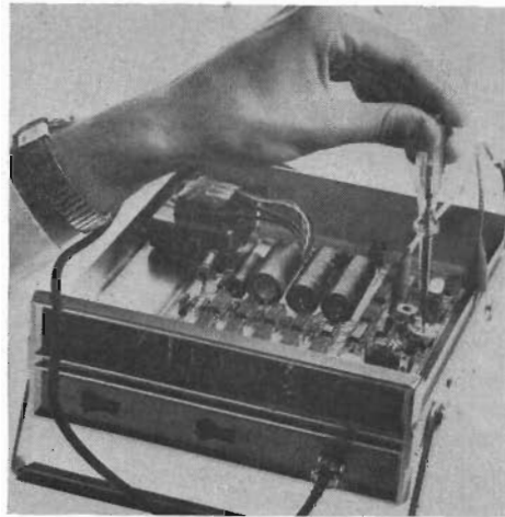
Fig 3. Inställning av känsligheten. Med den medföljande testsladden tas signal ut från referensoscillatorn och påförs ingången varefter trimpotentiometern vid Schmitt-triggern ställs in för max känslighet.
