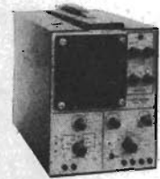
IO-102 Transistoroscilloskop Bandbredd DC-5MHz Känslighet 30mV/cm Pris: byggsats Kr. 990:— Pris: monterad Kr. 1.360:—
