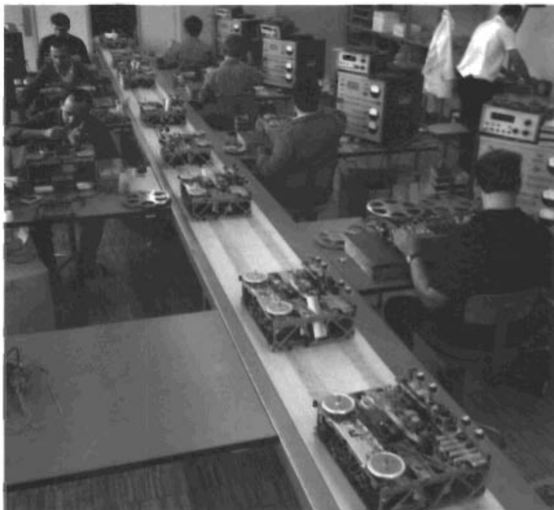
Fig 21. Så en glimt av monteringen, där det löpande bandet mera är en transportör än ett redskap för tempoarbete.
