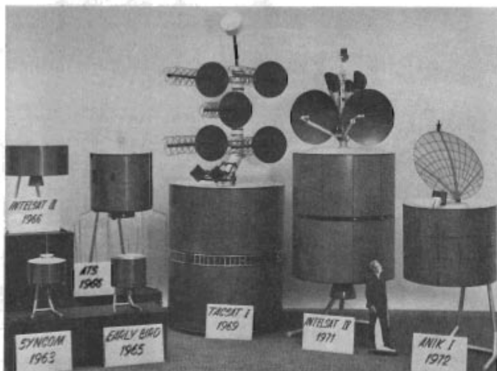
Fig 1. Några modeller av synkronsatelliter från 1963 och fram till idag. Skala 1:3. Den senaste, "Intelsat IV", är 6 m hög och 2,5 m i diameter. De båda parabolerna är vardera 1,25 m.
