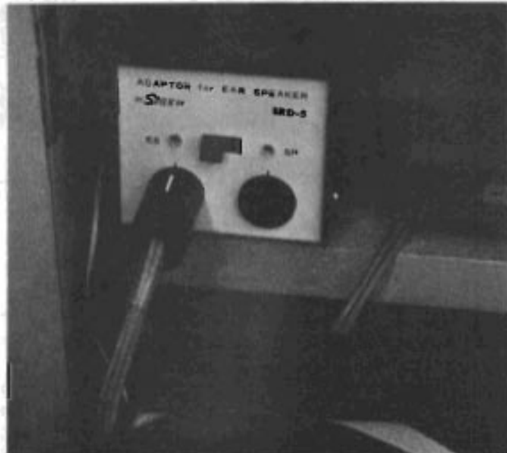
Fig 3. Nät- och spänningsaggregatet till den elektrostatiska hörtelefonen heter oförändrat SRD-5. Omkopplaren i läge hörtelefonlyssning. Anslutningsmöjlighet finns för ännu ett par "lurar". Jfr storleken med Quad-förförstärkaren, som skymtar th. Den kan strömförsörja enheten, vilken i det provade utförandet har ASA-kontakt (lätt att ändra till gängse svensk kontaktstandard och ansluta till vägguttag om man vill).
