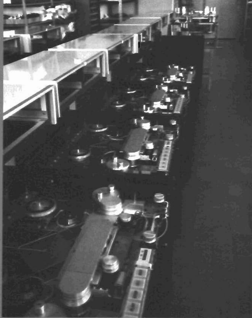
Fig 16—19. Produktionen av A 80 har tagit fart, men några jätteserier går ju en dylik bandspelare inte ut i. Mycket av färdigställandet sker för hand och många maskiner byggs efter kundspecifikationer — man kan ju välja antal kanaler, inbyggnadsenheter m.m. Här växer chassierna fram.
