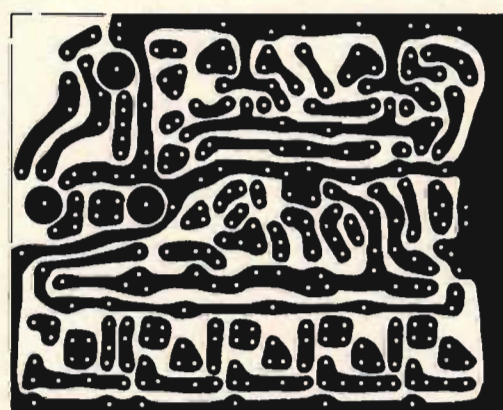
Fig 5. Kretskortet i skala 1:1 och sett från foliesidan.
