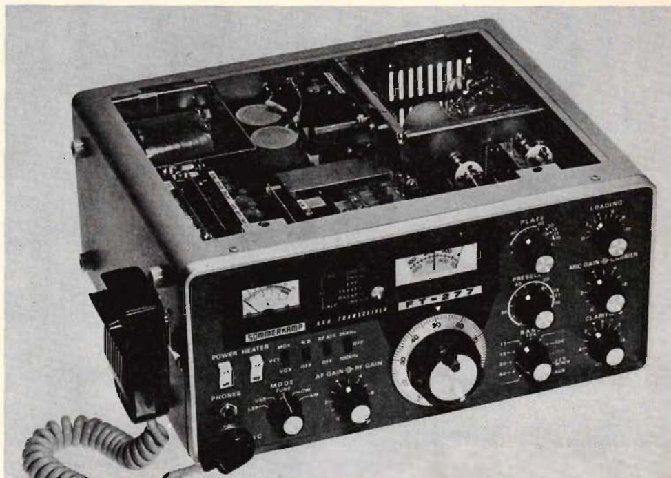
Fig 1. Transceiver med avtaget lock. I förgrunden till vänster skymtar de vertikalt monterade kretskorten som är anslutna i en kontakt på huvudchassiet.
