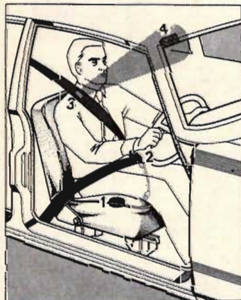
Fig 1. Så här fungerar det elektroniska bilbältet: När föraren — eller passageraren — sätter sig, trycks en kontakt ner i sätet (1). När man sedan spänner fast bältet sluts en annan kontakt (2). När slutligen bältet är justerat, sluts tändningskretsen genom en ultraljudsignal från en sändare i bältet (3) till en mottagare på vindrutans övre kant (4), och först då kan motorn startas.
