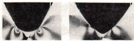
Fig c. En elliptisk nål vällar en större temporär deformation mot skivspårens väggar än nykonstruktionen. Enligt uppgift är fotona tagna vid 2 p nåltryck.
