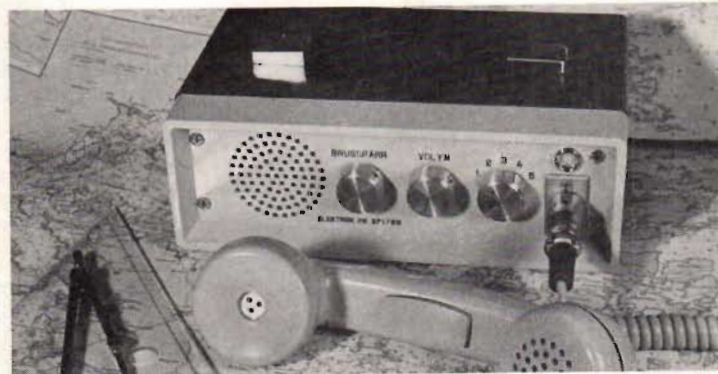
Elektron PS 271/5B ger ett intryck av robust bruksvara. De släta, runda rattarna på prototypen kommer att bytas ut mot kantigare sådana som är lättare att få grepp om med våta och kanske frusna fingrar.
