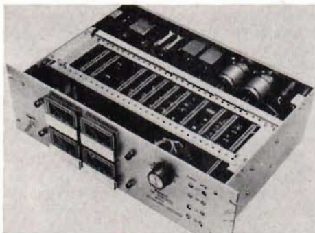
Fig 3. Samma encoder med avtaget metallhölje upptill. Genomgående är elektroniken sammanförd på instickskort i radmontage.
