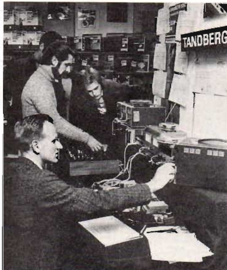
Fig 1. Här skockas allvarliga och spánt avvaktande bandspelarägare kring Tandbergs mät-team någonstans i Sverige (Östersund?) där man dragit in hos en radiohandlare. Närmast kameran instrumenteringen i form av oscilloskop, räknare, svajmeter och så Hewlett-Packard-enheterna för spänningsmätning och klirrförekomst. Det är tydligen en Beomaster som förts till test här.
