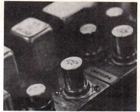
Fig 4. En förstärkare där rören ersatts med Fetroner.
