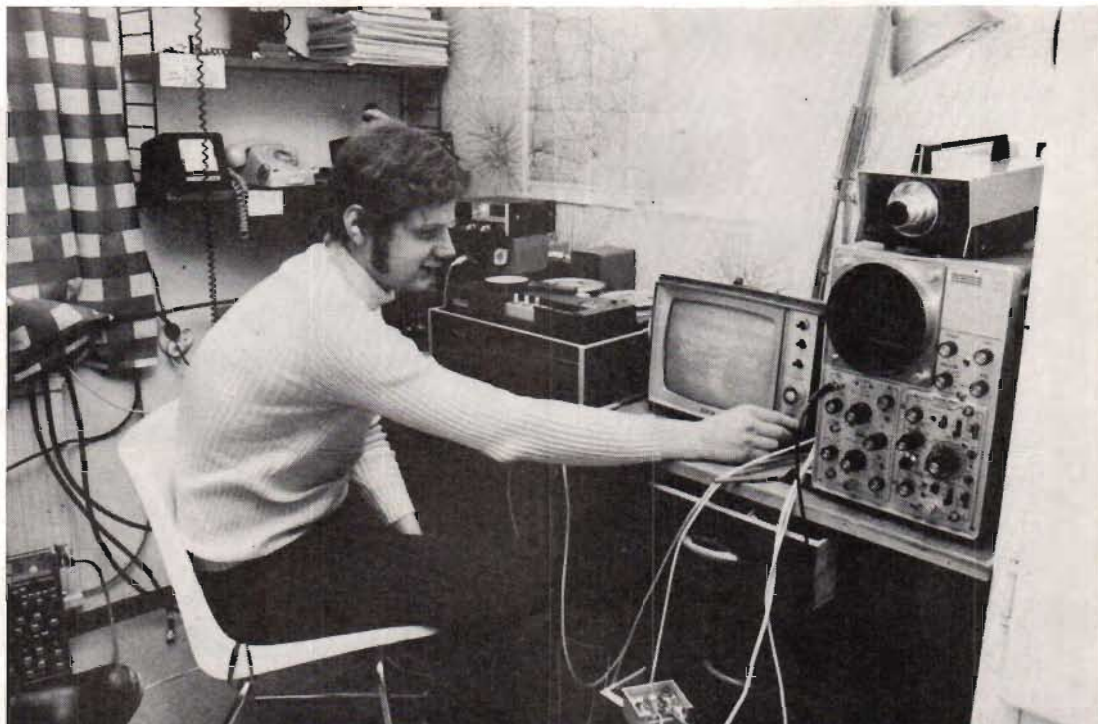
Fig 1. Operatören SM5DWC vid sin UHF-TV-station. Som synes finns här både oscilloskop för övervakning av modulationsgrad och synkulsutstyrning samt videobandspelare för att kunna bevara bildöverföringarna.
