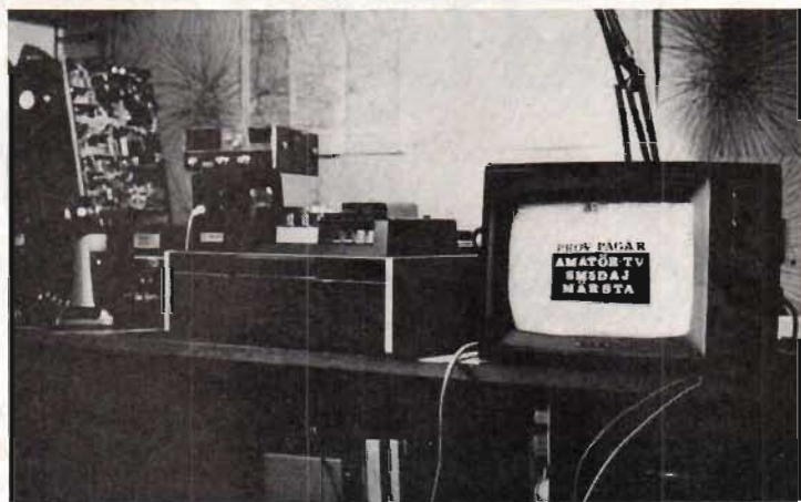
Fig 1. Operatören SM5DWC vid sin UHF-TV-station. Som synes finns här både oscilloskop för övervakning av modulationsgrad och synkulsutstyrning samt videobandspelare för att kunna bevara bildöverföringarna.
