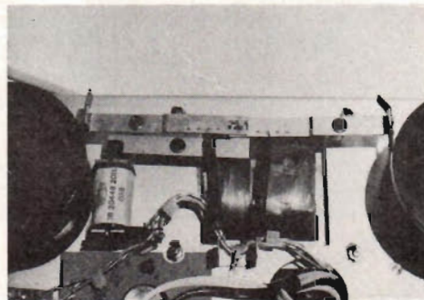
Fig F. Här ett närmare studium av bandbroms-arna. Nättrafon sticker upp i mitten. Detal-jen med bländare/fotomotstånd framgår dock inte, den syns i fig E.
