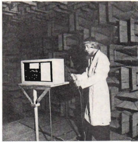
Fig A. Ekofria mättrum av absolut tillförlitlighet och jämnhet i frekvensgången, alltså utan oönskade resonanser, är inte alldeles lätta att åstadkomma. Till sin fysiska karaktär är sådana mättrum snarlika i all världens laboratorier. I princip befinner man sig med mätobjektet, mätmikrofoner och övriga anordningar på ett grovmaskigt "golv" av stål nät, spänt ungefär i rumskubens mitt; under sig har man alltså det omslutande absorptionsmaterialet. Här en interiör från det i texten omskrivna mättrummet vid KTH:s Institution för tillämpad elektronik. Den sondliknande mätmikrofonen hålls i handen för att visa monteringen. — På den ena bilden syns det vridbara stativ som får bära upp högtalaren, här en AR under installation.
