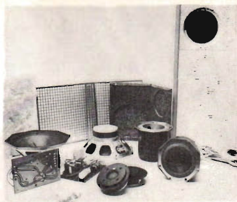
Fig 8. Materialsatsen till OM-högtalarna, minus ena höljet. Tv och i mitten delningsfiltren, tv dämpmaterial (blott en "kudde" medtagen i fotot) och i övrigt högtalarelementen med diskantenheterna framtill.
