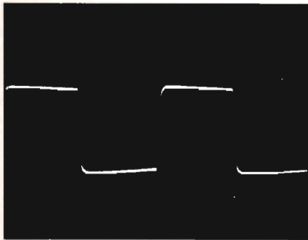
Fig 6. Kantvågssvar, uppmätta vid 1 W och 8 ohms last: a) 100 Hz b) 1 kHz c) 10 kHz
