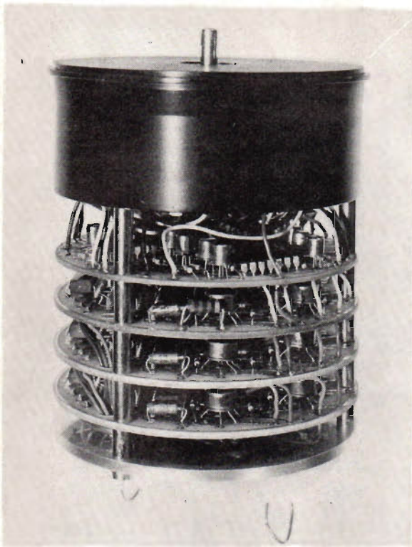
Fig 7. Kodgivare från Siemens med kontaktlös hallgeneratoravkänning för vinkelangivelse. 1 000 pulser utfås per varv.
