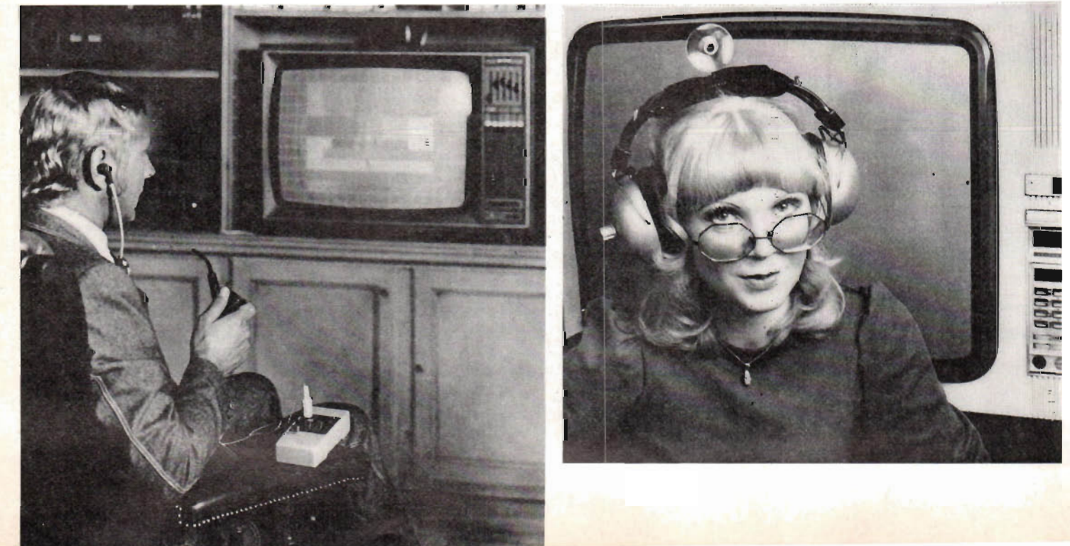
Fig 13. Två företag lanserade modeller med trådlös överföring av ljudet till hörtelefon. Philips (tv) modulerar tonen på ultraljud, som sänds ut från TV-mottagaren och tas emot i fjärrkontrollboxen. Nordmende (th) överför tonen på en infraröd ljusstråle, som kräver en speciell typ av hörtelefon med IR-detektor.
