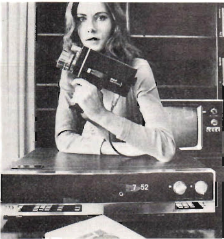
Fig 10. Under den äldre beteckningen Selecta Vision introducerade RCA en ny videokassettspelare i Europa. Den arbetar med 3/4"-band, men är inte kompatibel med någon av de övriga systemen.
