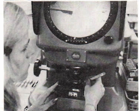
Fig 8. Bilder från tillverkning och provning av Teldecs skivspelare vid fabriken i Berlin. Kontrollen av de olika delarnas funktion är minutös och bl a använder man mikroskop för att ställa in nålens läge i själva pick upen.
