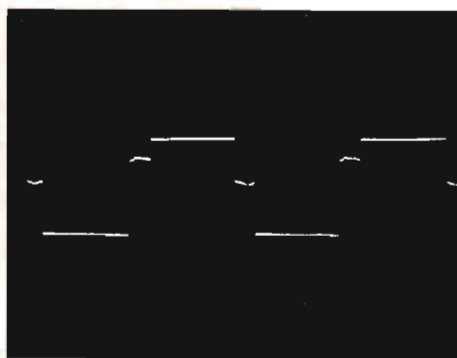
Fig 13. Fotot visar utsignalens utseende då en fyrkantsignal har påförts ingången. Här har insignalen gått från hög till låg mitt under en samplingsperiod, vilket förklarar kurvans egendomliga utseende.
