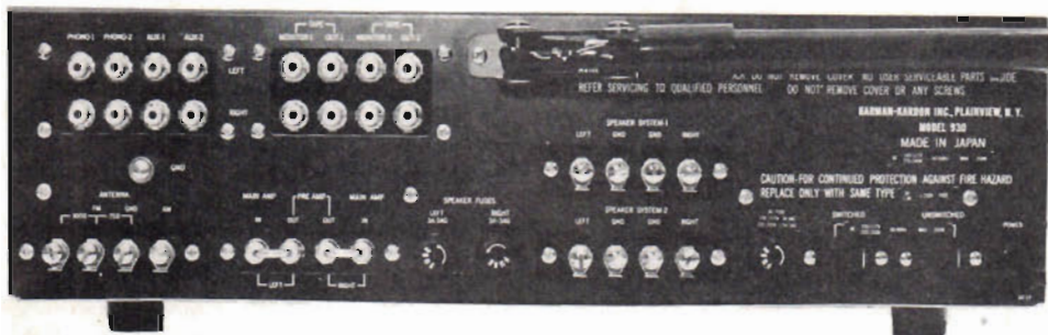
Fig 2. Bakre panelen till H/K 930. Märk de metalliserade byglarna för de båda förstärkarstegen separering. Konventionella skruvlistor och kontakter. Påfallande är att konstruktören inte ansett sig behöva disponera bakstycket för sluttransistorernas kylning — här finns inga "heat sinks" om leder ut värme direkt mot omgivningsluften. Jämför t ex den i novembernumret provade Sony-förstärkaren.
