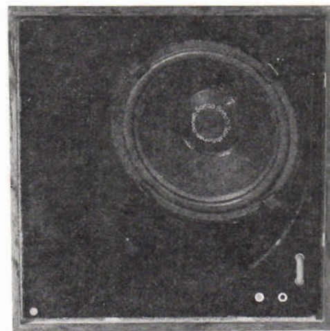
Fig 2. Under gallret över toppen till MaxiMin ser högtalaren ut så här med diskantkorrektionsbygeln upptill åt höger.
