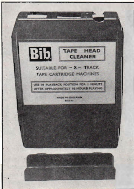
Fig 6. Små prisbilliga tillbehör har vuxit upp i kasseteknikens spår: Här är en magnetonhuvudrengörare av märket Bib, engelska audiodetaljer för de flesta användningar, och bildens rengörare passar 8-spårskassetter. Under ca 60 s håller man den mot huvudena med kassettdäcket i avspelningsläge. Behandlingen upprepas efter var tionde driftimme.
