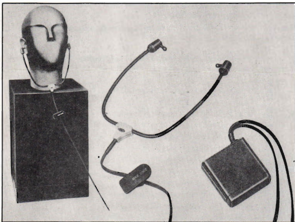
Fig 9. De här okomplicerade komponenterna utgör MKE 2002-systemet: Gubben, lådan, stetoskopmikarna med sin kabel och clipset samt batterihöljet med sin kontakt.
