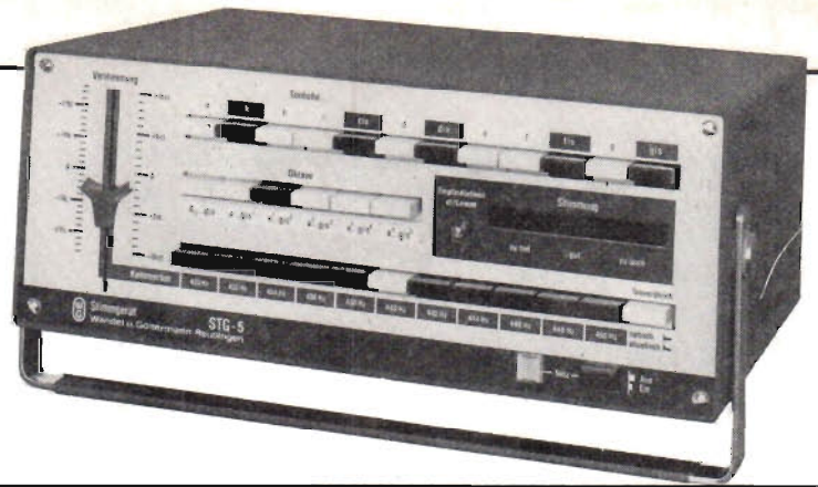
Fig 2. Elektroakustisk stämninggenerator typ STG-5 från Wandel und Goltermann i Västtyskland (sv. repr Wandel und Goltermann, Älvsjö). Instrumentet har ett frekvensområde från A_2 till a^5 (27,5 – 7040 Hz). Kammartonen a^1 kan kontinuerligt ändras från 425 – 452,5 Hz. Frekvensnoggrannhet > 1 cent.
