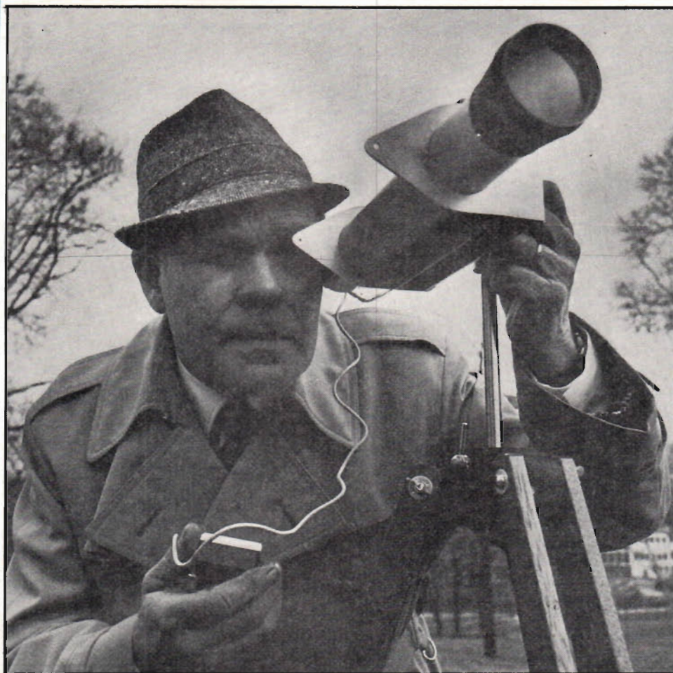
Fig 4. Sändaren (överst) och mottagaren monteras i var sitt PVC-rör som i sin tur förses med stödgavlar. I dessa kan hål borras upp för att tjäna som sikte vid riktningen.
