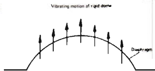
Fig 7. Så här tänker sig JVC-teknikerna att skillnaderna blir mellan de utslag som ett konventionellt, "stelt" membran gör jämfört med en mjukbehandlad kalott, som skall komma nära idealet "den pulserande hemisfären" med likformiga, icke-pistongliknande rörelser hos konen, teoretiskt optimalt.
