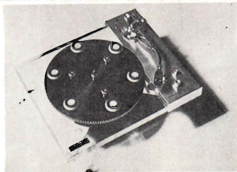
Fig 18. Här är Cinecos Mark 2002, "en femstjärnig skivspelare", säger den franska firman... Märk stroboskopmarkeringen runt skivtallriken à la äldre Garrård-verk, en bra detalj.
