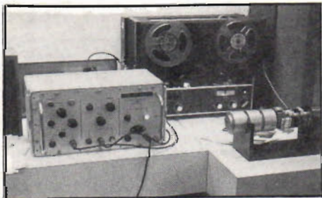
Fig 9. Marconi 023 ARL talomvandlare. Den användes vid talöverföring från dykare på stora djup. Dykaren andas helium/syreblandning, vilket distorderar talet. Omvandlaren gör talet åter tydbart.
