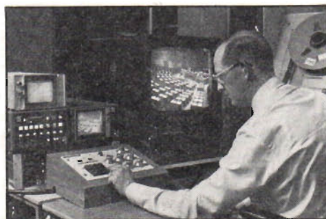
Fig 2. Kontrollutrustningen på SR. Här sker fjärrstyrning av kameran och bandinspelning.
