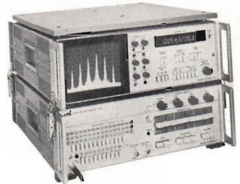
Fig 11. Den nya digitala spektrumanalysatorn från Marconi: TF 2370. Bilden omvandlas och lagras i ett digitalt minne.
