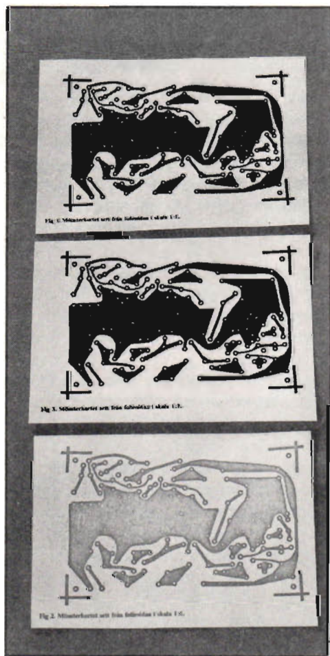
Fig. 1. Denna illustration visar, räknat från ovan, originalillustration av ett kretskortsmönster, klippt ur Radio & Television. Mellert visas en kopia, framställd genom fotostatkopiering av det slag som erfordras. Nedert på bilden en fotostatkopia av det slag som ej duger till kontaktkopiering på lithfilm. Signifikativt för denna typ av fotostatkopia är de mörkare partierna i mönstrets ytterkanter, vilket ger en ljusare avtoning mot mönstrets mittpartier.
