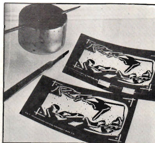
Fig 2. Så här genomskinligt måste ett negativ vara, avsett för kontaktkopiering på det med resistvätska försedda kretskortslaminatet. Genomskinligheten illustreras här genom att texten är lika klar utanför negativets kanter, som där den kan läsas genom negativet.
