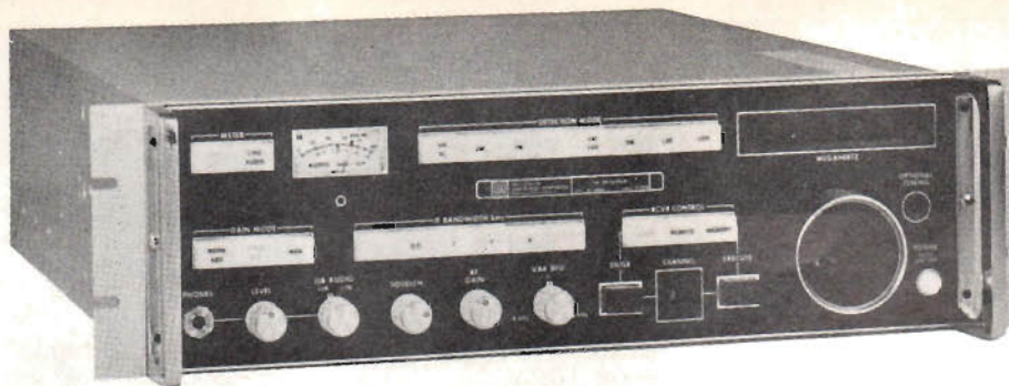
Fig 4. WJ-8888 från Watkins-Johnson. Den har inbyggt minne för att kunna lagra 16 inställningar.
