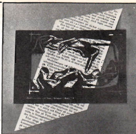
Fig 2. Så här genomskinligt måste ett negativ vara, avsett för kontaktkopiering på det med resistvätska försedda kretskortslaminatet. Genomskinligheten illustreras här genom att texten är lika klar utanför negativets kanter, som där den kan läsas genom negativet.
