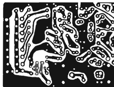
Fig 2. Kretskortet sett från folie-sidan i skala 1:1.
