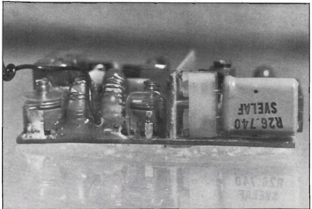
Fig 4. Så här monteras kristallhållaren.
