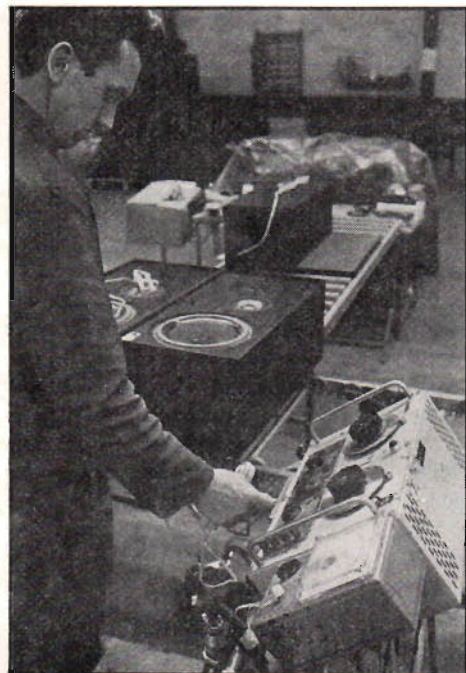
Fig 7. De färdiga elementen förenas via sina bafflar med höljen och dämpmaterialet i en högrationaliserad sammansättningsfabrikation, där också varje högtalare får sin slutliga provning. Här ses ett par ITT-lådor av treelementstyp undergå sveptestning med ett Radiometer-instrument hos Scan-Speak.
