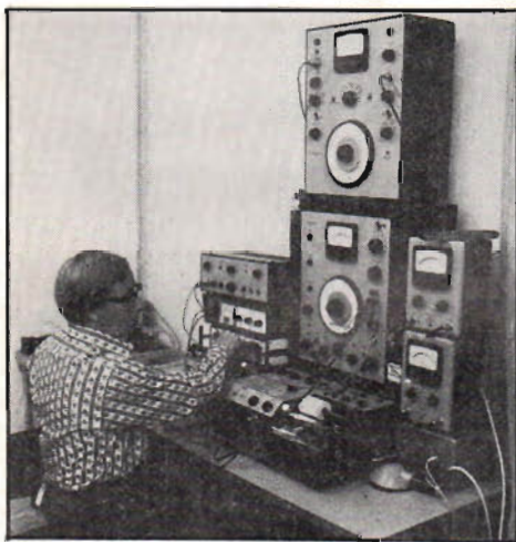
Fig 1. Den här instrumentuppsättningen, som Ragnar Lian har tillgång till för sina mätningar och sitt konstruktionsarbete, står framför ett av de ekofria rum han inrett i Scan-Speaks fabriksbyggnad i Hørning utanför Århus på Jylland. — Instrumenteringen är Brüel & Kjærs av den typ RT:s tester vanligen genomförs med (sveposcillatorn och nivåskrivaren i mitten) resp Eldorado (funktionsgeneratoren som här får bestå signalformen). Ovanför funktionsgeneratoren ett hembygge av Lian; en fasvinkelmeter. Märk reflektorn till stroboskopet t h på labbänken.
