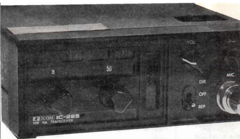
Fig 5. Panelen visas här med sina reglage för inställning av frekvens. Längst upp till vänster syns MHz-omkopplaren. Den vänstra ratten avser 100 kHz steg och den högre ratten kontrollerar 25 kHz-stegen. Visarinstrumentet på panelens mitt visar HF-effekt ut eller signalstyrka vid mottagning.
