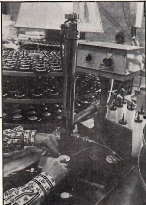
Fig 4. Momenten vid högtalarelementframställning är många, och olika dopingförfaranden av koner och (här) kalotter som utgör membranens hjärtpunkter sker längs olika stationer. Centrerings av kalotterna mot chassistommen är viktigt.
