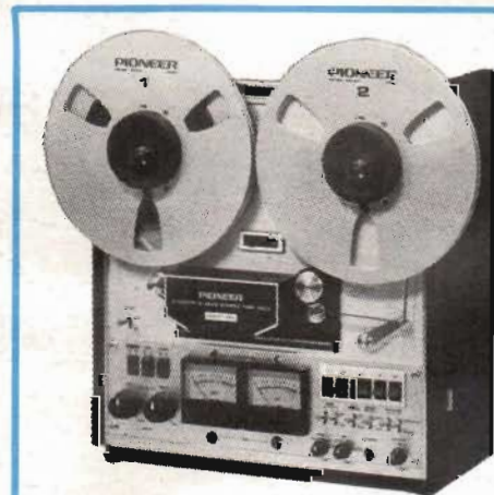
Fig 3. Kanske får vi på nytt ett bestånd högkvalitativa bandspelare på vår marknad? Pioneers RT-1050 är top of the line hos den firman och med 19 och 38 em/s hastigheter plus en rad användbara drag som flerläges förmagnetiseringsställning och bandkompensationer, elektromekanik och lovande bandtransportlösning, tre-motordrift m m är maskinen en av de få som lämpar sig för halvprofessionellt bruk i olika sammanhang. Men ingen import är att vänta reguljärt förrän tidigast under 1976.
