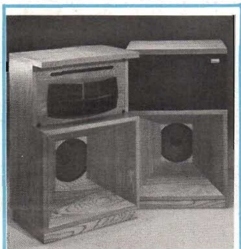
Fig 13. Absolut ovanligt för att vara en japansk ljudkälla är hornet CS-H9 från Pioneer, eller rättare kombinationen bashorn och flercellhorn å la Altec, USA. Till CS-H9 hör egentligen en ultradiskantstrålar som ska förläggas ovanpå högtalaren. Vikt ca 46 kg, ljudtrycksalstring 100 dB/W! Mycket kraftiga och solida komponenter ingår som drivenheter och filterdelar, t ex. nivåkontroll med ett omkopplarved i filtret.
