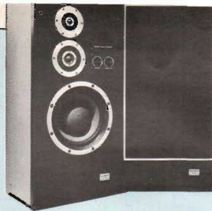
Fig 15. Sonys 100 W-högtalarsystem i form av stora basreflexlådor och med de sk Carboconmembranen: SS 8150. Kolfiber har förenats med konens papp, vilket givit en lätt men styv och lågresonant karakteristisk liksom god resistens mot konuppsträckning.
