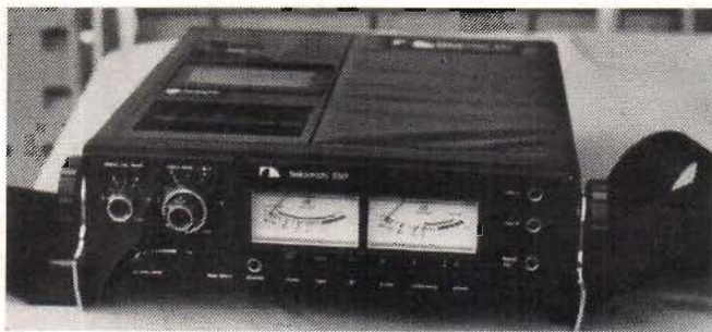
Fig 1. Normalt driftläge är att kassettspelaren läggs ned på en flat yta varvid de stora rembyglarna till bärorden kan vinklas så att deras raka del utgör stöd. Nakamichin kommer därvid att ligga svagt uppåtlutad mot användaren, som har bästa uppsikt över inspelningsen.
