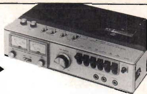
Fig 2. Den flott utformade JVC 1635 som erbjuder både brusreduktionselektronik, ny, mycket effektiv och strömsnål motor med ca tre gånger bättre ekonomisering med batteriströmmen än tidigare (6-9 V konstantomvandlas till 24 V före förstärkning) samt bestyckning med det nya SA-tonhuvudet som beskrivs i texten. Instrumenten är VU-graderade.
