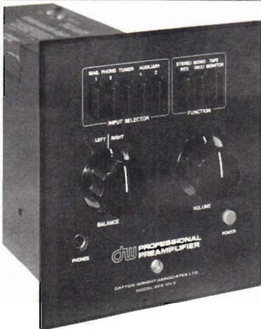
Fig 3. En definitivt icke-vardagsrumsfrände förstärkare: Dayton-Wrights SPS Mk 3. Märk tryckknappsväljarna för de få funktioner som bjuds i denna "helprofessionella" apparat.
