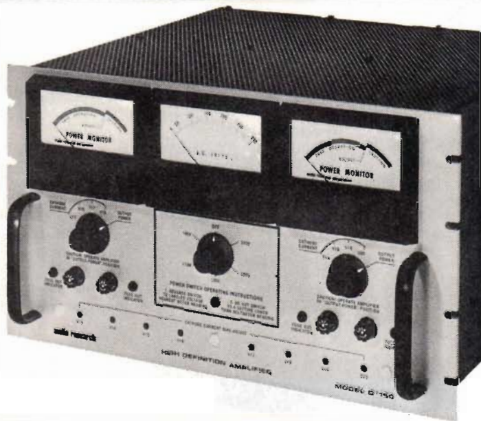
Fig 6. The Real Thing, enligt många: Audio Researchs "High Definition Amplifier" D-150. Märk växelspanningsvoltmeters i mitten! Utöver den två "power monitors" med indelning å la bils varvräknare med färgade fält - Caution motsvarar här typiskt övervarvornråde. Här går sannerligen ström genom steget! Frontpanelen erbjuder en hel läsebok av Operating Instructions (märk t ex katodströmreglaget!). Man letar bara förgäves efter switcharna till magnetstarten, hydraulpumparna, brandvarnarna för motorerna och dragreglaget till efterbrännkammaren vid Mach 1 och upplysning om rätt varvtal och temperatur på turbinen.
