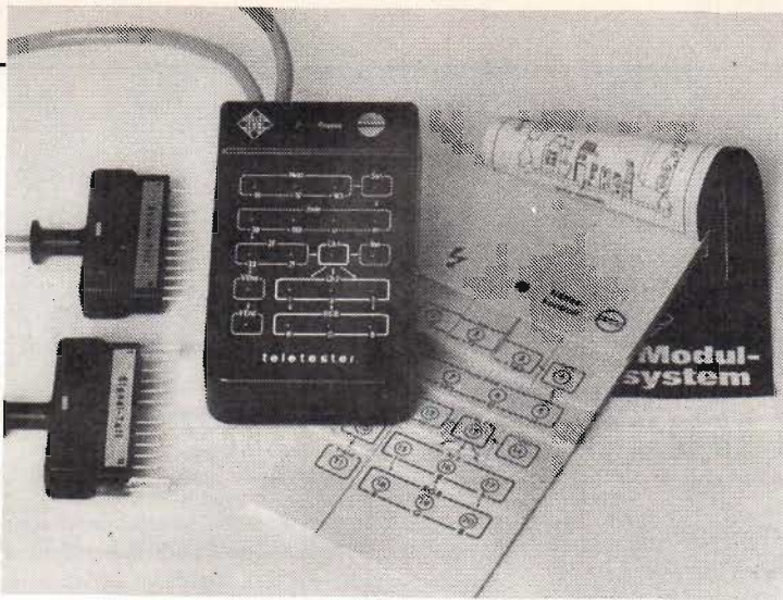
Fig 2. Diagnosadaptorn teletester har 20 lysdioder som indikerar fel. En tabell visar sedan vilka moduler som kan vara defekta. Diagnosadaptorn ansluts med två tolvpoliga kontakter till avlänkingsdel och till signalkretsar.
