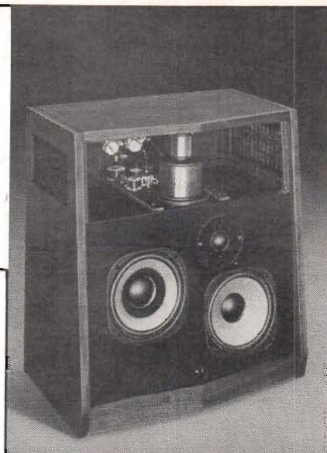
Fig 10. Det yttre av den nya stora högtalaren HPM-200 från Pioneer. De dubbla baselementen har fått en blandning av en speciell karbonfiber inblandning i pulpen eller pappmassan som konen pressas av. Detta har givit ett mycket lätt men styvt konmaterial utan tendens till uppspräckningar eller delvisa oscillationer. Mycket gynnsam elasticitetsmodul har också uppmätts med materialet i jämförelse med både glasfiber och bomullstråd.
