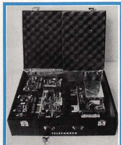
Fig 1. Här visas Telefunkens serviceväska med några av de 14 modulerna. Observera den praktiska skumplastinredningen. Man har alltså avstått från att göra fack speciellt för de olika delarna. De felaktiga modulerna skickas till Telefunkens verkstäder i en specialförpackning av styrolit.
