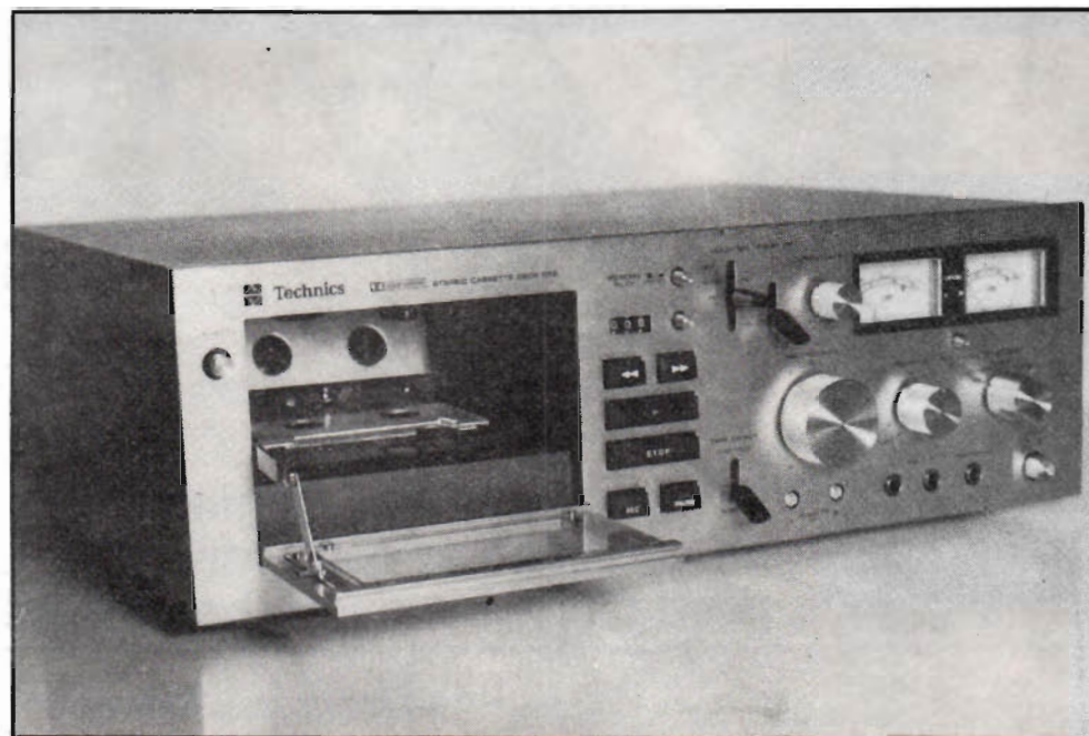
Fig 4. Frontmatningen försiggår genom en nedfällbar lucka och kassettschaktet, som är belyst, är i "tak" klätt med en spegel som visar läget för kassetten. Den ska i sin driftposition vara nersänkt i mekaniken. Det kan vara lite svårt att se om spolarna går, p g a vinkeln man får kika in i. De flesta stora kassetbandtillverkare har numera enats om att förse kassetthöljerna med en identifieringsmärkning för krom. I Technics-däcket sker automatiskt omkoppling för den bias och den frekvenskaraktistik som krävs för dessa band vid "avkänningen" av höljet. Man behöver inte själv operera omkopplaren på fronten till kromläge annat än för det fall kromdioxidbandkassetten skulle sakna denna nyare slits eller märkning.
