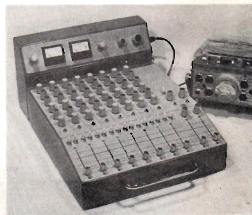
Fig 1. Jämförelsen med Nagra-maskinen visar storleken av SELA:s nya portabla "modul"-mixer 2880-ST för stereoproduktioner. Toppvoltmetrar från N Tønnes Pedersen. Se texten för detaljer.
