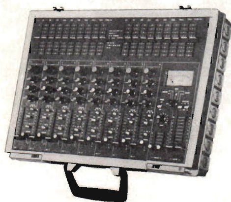
Fig 2. AVAB:s portabla mixer ME 802 med FK-variator, inbyggd i en väska. Vikten är 7,5 kg. Flera utföranden finns, bl a MP 532 med slutsteg i höljet — 2 X 60 W; för scen- och restaurangbruk och mindre krävande inspelning.
