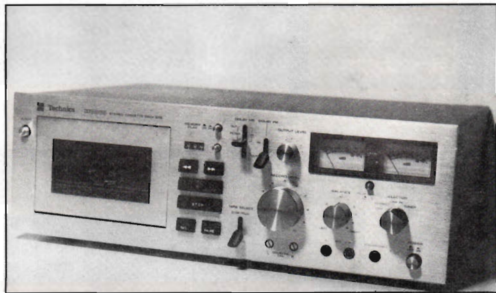
Fig 3. Technics påkostade skapelse 676 RS har dubbla Dolby-system, 25 \mu s tidkonstantselektor, "medkännande" utstyringsinstrument som går att koppla om för toppindikering, DC-kontrollerad huvudmotor plus separat spolmotor, en hel räckta finesser i styr- och reglerelektroniken samt 70 \mu s tidkonstant för avspelningskorrektionen för kromdioxidtape.
