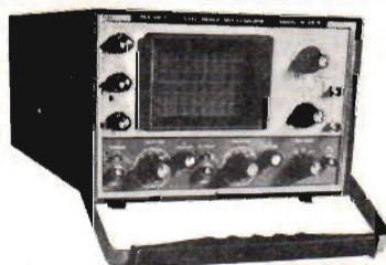
IO-4510 DUBBELSTRÅLE-OSCILLOSKOP DC-15 MHz, känslighet 1 mV/cm Trigger upp till 45 MHz Signalfördröjning 20 ns Pris: byggsats 3.480:— monterad 4.650:—
