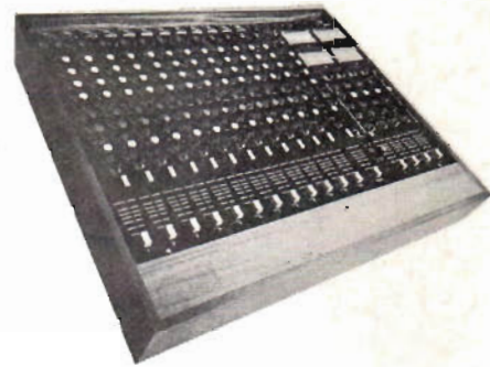
Fig 7. Till Sverige kommer Soundcraft-programmet bl a i form av denna "12 i 4"-mixer, som går att göra 4-kanalproduktioner med. Den flata byggestilen har prefererats här. Kontaktanslutningspanelen ligger alldeles öppen bakom ingångsskenor och signalbehandlingsorgan. Dämpatsernas ursprung är obekant.
