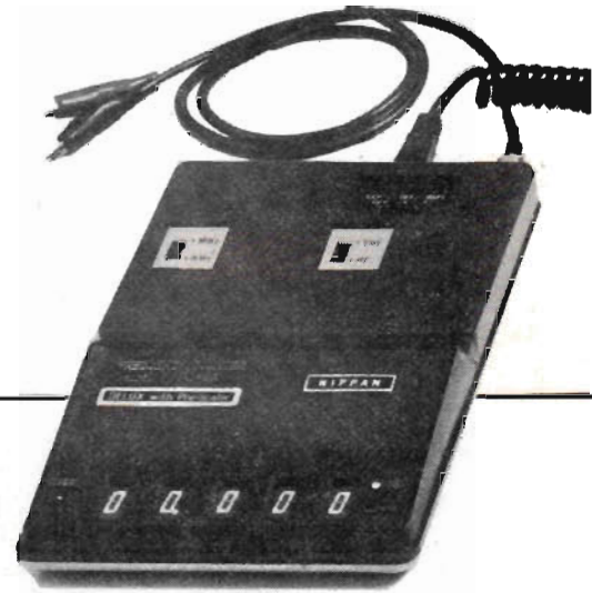
Fig 6. Frekvensräknare i miniatyrformat. Finns för frekvenser upp till 250 MHz.
