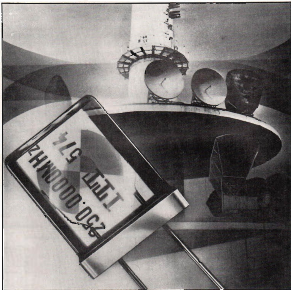
Fig 1. Kvartskristall för telekommunikationsutrustning. Sjelva kristallen är lika tunn som ett människohår (ITT Bauelemente).
