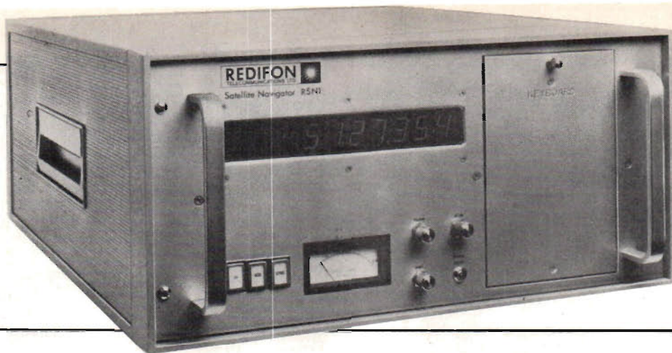
Fig 7. Mottagaranläggning för satellitnavigation av fabr Redifon, typ RSN1.
