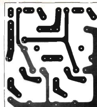
Fig 3. Krets-kortet i fig 1. Kortet visat i skala 1:1 från foliesida
