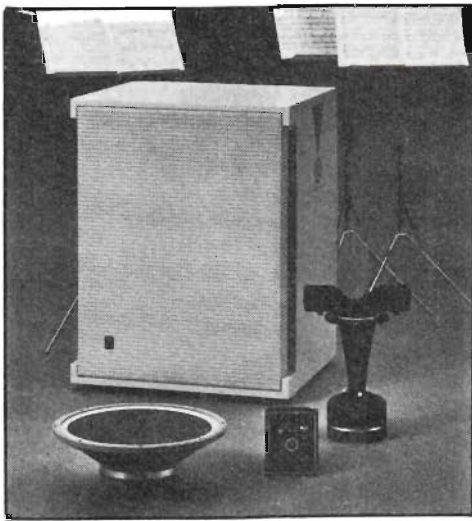
Fig 1. Så här ser J B Lansings världen över använda studio monitor S 7 ut. Höljet mäter sex kubikfot och hyser en LE 15 A bashögtalare, en gle 85 diskantdrivenhet ihop med HL 91-hornet och den s k akustiska linsen vi tidigare beskrivit, plus LX-delningsfiltret. Högtalaren väger ca 60 kg. Baselementet är en femtonummare med en magnetstruktur som väger ca 8 kg. Talspolen är av koppar, 4 tum lång. Konen har en speciell JBL-elastisk materialupphängning. LE 85 tar vid över 500 Hz: Exponentialhornet 91 och den trattbaserade linsen med sina diffusorer av metall bildar mellanregister- och diskantstrålare i LE 85-montaget, som har en aluminiumtalspole i ett mycket starkt magnetfält och vidare en impedanskontrollerande ring av rent silver för att systemet ska ge maximal linearitet över sitt tonområde. S 7 har funnits i många år med delningsfiltret LX 5, som använder handgjorda(!) pappers- eller Mylarfilmkondensatorer med högst 5 % toleranser.
