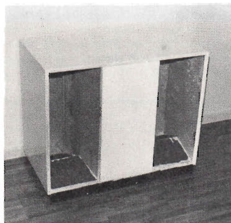
Fig 8. Högtalarelement, frontpanel och bottenstycke är här på plats. Dessutom är kompensningsbitarna (17) och (18) monterade.
