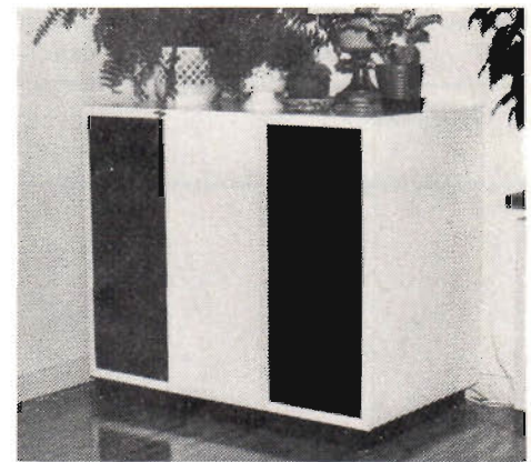
Fig 9. Lister, som sprutmålades samtidigt som högtalarlådan, täcker här skruvhålen för frontstycket. Listerna är något bredare än spånplattans tjocklek, 22 mm resp 16 mm, och ger därför en kant som håller skumplastbitarna på plats. Ett glest galler av tunna trälistor innanför skumplastbitarna hjälper till att hålla dessa plana. Skumplast kan anskaffas från LW Ljudteknik, tel 08-29 07 76. (Skumplasten har givetvis bara en estetisk funktion att fylla.)
