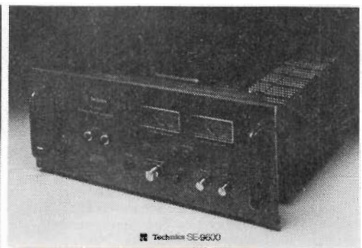
Fig 15. här är svart- och kromglänsande super fi-apparaterna med t o m stativmontagefront och handtag är Technics SU-9600/SE-9600 som beskrivs i texten. Märk tonkontrollkurvorna på kontrollförstärkarens överplatta! Kylflänsarna t h på slutsteget är mycket solida; i mitten ligger trafon och ett par stora elektrolytkondensatorer. De här enheterna hör till de gedignaste man kan få någonstans och tävlar med USA:s elitklassade produkter.
