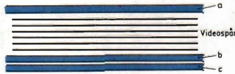
Fig 2. Spårmonster producerat med längsgående registrering. Spåren a, b, och c är också här för ljud, synkpulser och medhörning.
