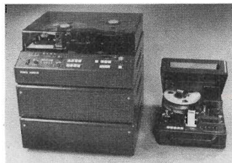
Fig 1. Videobandspelare från Bosch/Fernseh. Till vänster BCN 50 och den bärbara bandspelaren BCN 20 i reportageutförande. 1"-band används.
