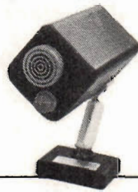
Fig 1. Snooperradar har inbyggd antenn, dvs vägledaren är integrerad med den IC-bestyckade elektroniken i höljet.
