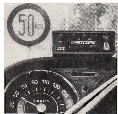
Fig 13. Denna hastighetsvarnare kan mycket enkelt kopplas in på alla typer av bilar och ger en akustisk varningston när någon av tre förinställda hastigheter överskrids. Inkopplingen består endast i att en pick up-spole fästs på baksidan av hastighetsmätaren.
