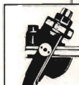
Tonarm, upphängd i 4-punkts spetslager, ger minsta möjliga friktion.
