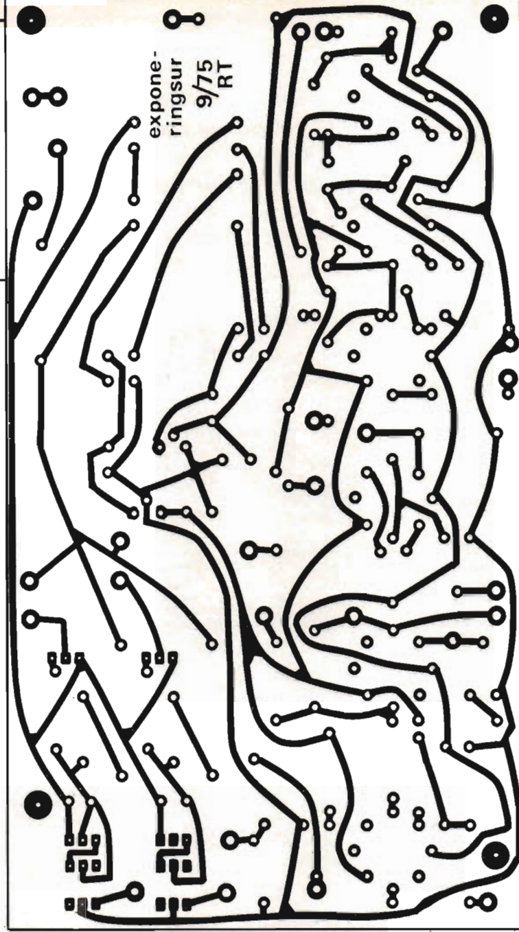
Fig 8. Mönsterkort i skala 1:1 (lödsida).
