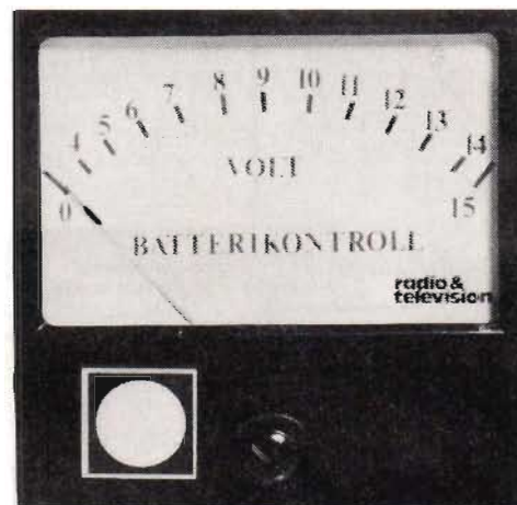
Fig 1. Batterikontrollinstrumentet färdigt för inbyggnad i bilen. Nertill tv syns en mekanisk beröringsströmbrytare som vi använt som återställningsdon i prototypen.
