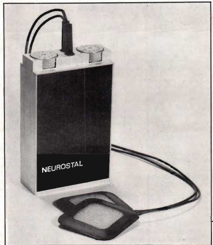
Fig 1. Neurostal hudstimulator. Apparaten är behändig och lätt att bära på sig. De två stimulationselektroderna är identiska, detta i motsats till andra former av biologiska elektroder, där man arbetar med en större indifferent elektrod och en mindre, aktiv elektrod. Med de två rattarna regleras spänning och pulsfrekvens (Dan-Sjö Elektronik AB, Sundbyberg).
