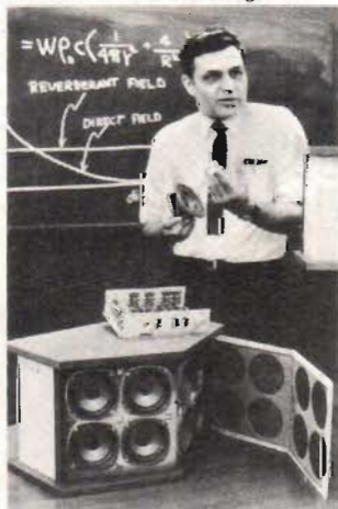
Akustikprofessor Amar G. Bose demonstrerar sin världsberömda högtalare modell 901, som har 8 högtalarelement riktade bakåt och 1 framåt och tål 270 watt!
