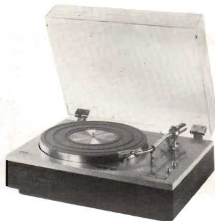
Fig 20. Yamahas P 800 har en 2 kg tung tallrik, spegelstroboskop, trefaldig tallriksisoleri och beröringskontroller. Hastigheterna kan regleras för 33 och 45 rpm med individuella kontrollorgan, som kan variera farten med \pm 3\% vid spelning. Armen är S-formad, hängd i gyrogimbalupphängning och gjuten i ett stycke. Friktionen understiger 10 mp i båda planen. Likströmsmotor av borstlös typ. 12-polig.
