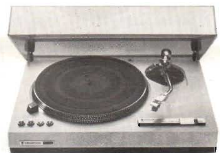
Fig 21. Kenwoods KD-550 finns av allt att döma både med och utan tonarm, vilket är tacknämligt för valfrihet. Direktdrift, ny, egen tonarm med likaså ny upphängning i pivot, som fästs i ett underlag av specialträ för lägsta resonansbenägenhet. Man kan få montage av SME-3009 på en av dessa specialträbaser. Strob-markerad skivtallrik och, givetvis, ett yttre stroboskop etc, dc-motor av borstlös typ med servo för frekvenskontroll. Hastigheten kan varieras inom 8 % med individuella reglage för 33 och 45 rpm.
