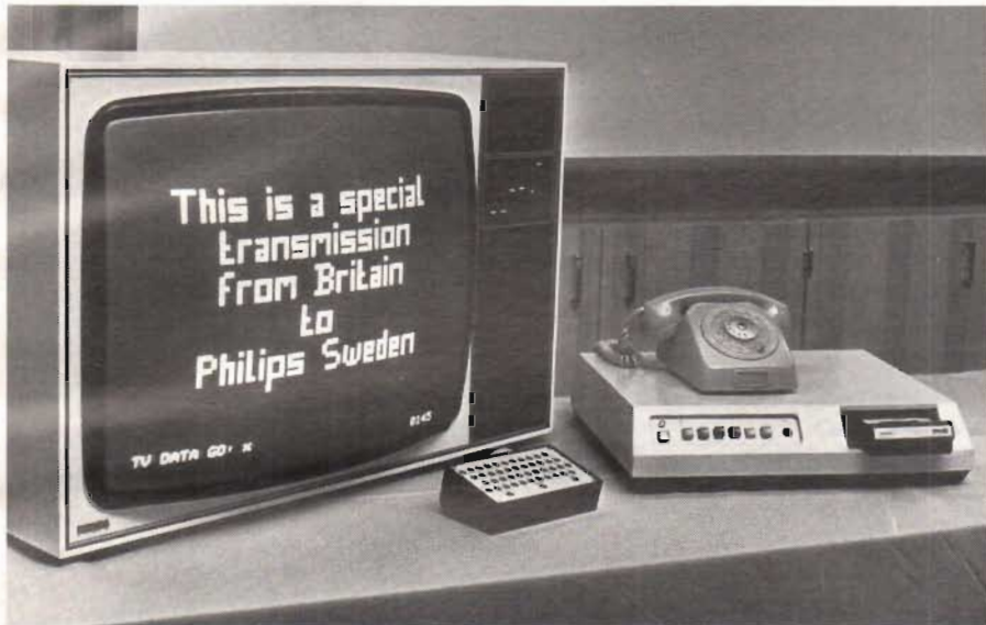
Fig 1. Här visas en hemterminal som utvecklats vid Philips forskningslaboratorium i England. Med telefonen ringer abonnenten upp en databank. Med knappsetsen framför TV-apparaten väljer man sedan önskad information ur databanken: t ex sportresultat, bioprogram, lokala evenemang. Man kan även sända information till en annan abonnent.
