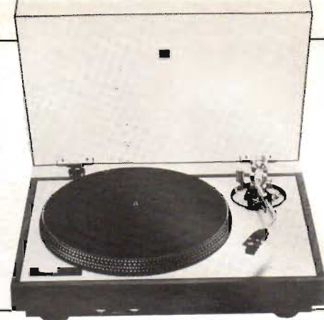
Fig 19. Luxmans 282 skäms heller inte för sig. Också direktdrift, ac-servomotor av 6-poltyp. S/N bättre än 60 dB. Tonarmen av S-form, 237 mm lång och med 15 mm överhäng. Pick upen blir en Audio Technica PM 512 B "eller motsvarande".
