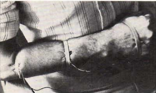
Fig 2. På detta sätt kan elektroden fästas för mätning av muskelsignalerna i en arm. Den jordade elektroden sitter i mitten med de signalförande elektroden på var sin sida.
