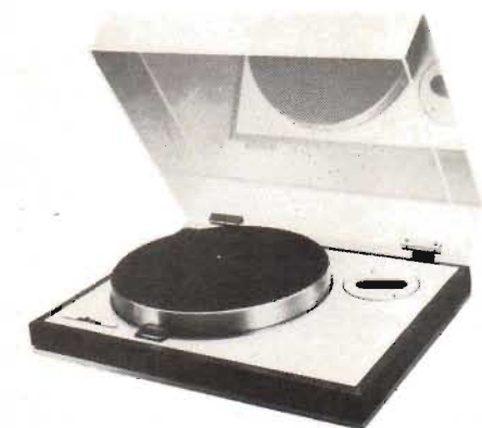
Fig 18. Luxman PD 121/131. DD-verk som kan fås utan tonarm. Helelektronisk, borstlös dc-servo-motor. Unikt stroboskop med "svart ljus", som pulsas mot en projicerad tablå, där linjefrekvensen 50 Hz står fram i gult. Mycket fin motorupphängning och en särskild bajonettinfästning av tonarmen. Stor omsorg har nedlagts på verkisoleringen med specialelement som utdämpats i flera lager med gummi och kiselfetter. Två hastigheter.
