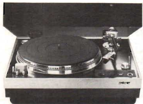
Fig 17. Kanske vackraste gramfonverket i den traditionella stilen: Sonys PS-8750, direktdriftverk med kristallstyrd servomotor och magnetdiskservo. Automatik tack vare en extra motor för tonarmen. Arm och p u-skal av Carbocon-materialet; hög styvhet, låg vikt, lägsta friktion och lågt muller. Lagring i rubinfattning i båda planen. Locket har ett "galler" för att ta ner ev statisk elektricitet mellan lock och skiva.
