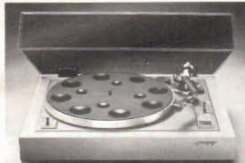
Sony PS-2350. Lättmanövrerad, halvautomatisk skivspelare. Kraftig synkronmotor. Lateralbalansvikt. Hydrauliskt tonarmslyft. Dämpad skivmatta. Hållare för extra PV-skål.
