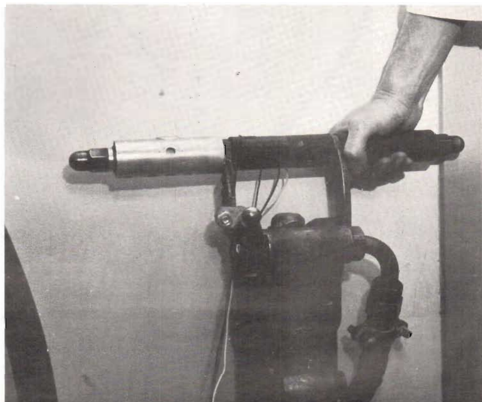
Fig 7. Mätare för samspelet mellan arbetare och hans maskin (bergsborr).
