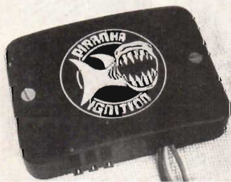
Fig 2. Piranhasystemet. Till de tre kontaktarna nederst till vänster ansluts optobrytaren.
