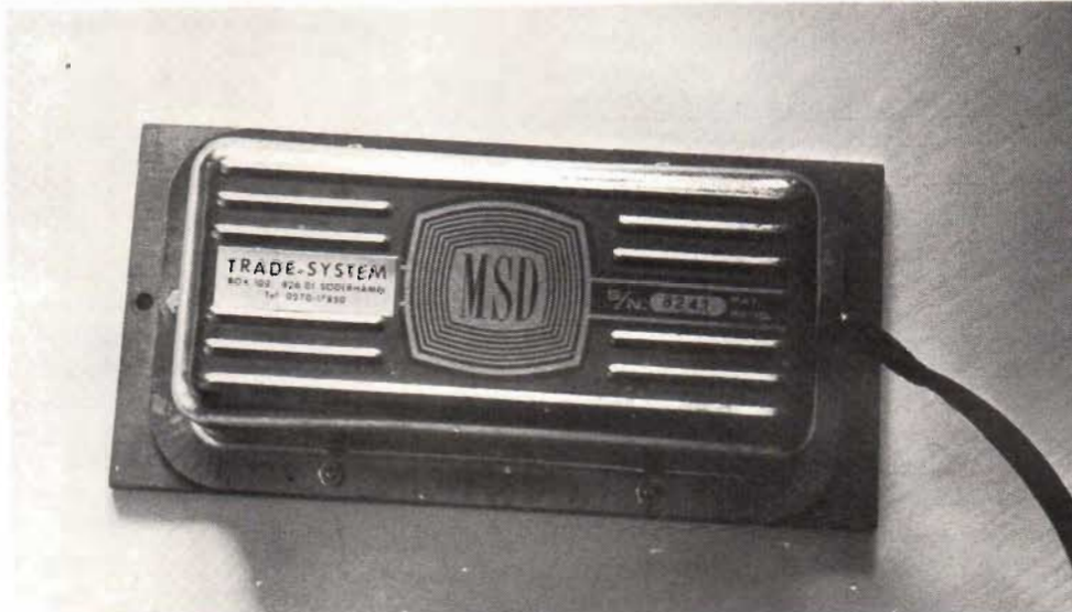
Fig 5. Multi Spark Discharge. Systemet kräver ganska hög matningseffekt och vi kunde konstatera att det guldfärgade höljet blev ganska varmt vid våra prov.
