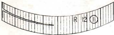
Fig 3. Typisk remsutskrift från ett ensamt fordon. Papperet rör sig nedåt, vilket innebär att tidsaxeln går uppåt. Större utslag åt höger innebär en högre detekterad hastighet.
