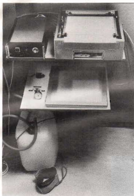
Fig 3. Registreringsenhet för fotvolymen. Överst t v ser man elektronikenheten och t h skrivaren.
