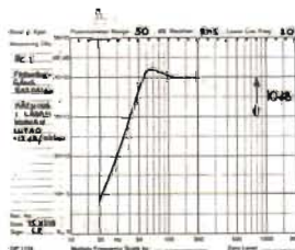
Fig 12. Högtalaren BC 1 utan inverkan av rumsresonanser. Mätningen är utförd i ett vanligt bostadsrum med mikrofonen placerad i lädan. Den uppkomna ljudtryckskurvan har sedan lutats 12 dB/oktav för att man skall få den aktuella ljudtryckskurvan i fritt fält.
