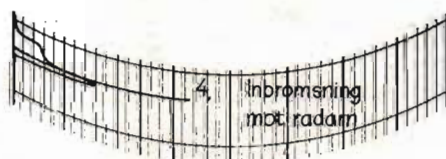
Fig 9. Ett fordon som bromsar in sin hastighet mot radarn ger denna signal.
