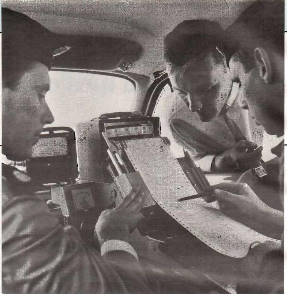
Fig 2. Registreringsutrustningen till S-5 placerad i en polisbil. Man ser det analoga visarinstrumentet t v och skrivarens remsa t h. Foto PeO Eriksson.
