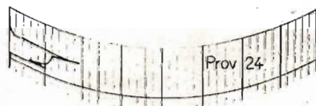
Fig 8. Denna uppteckning har bildats genom att signalen reflekterats två gånger mot det rörliga fordonet.
