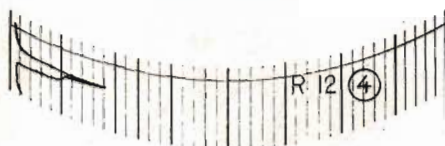
Fig 7. Registrering av två fordon som samtidigt befunnit sig i radarloben.
