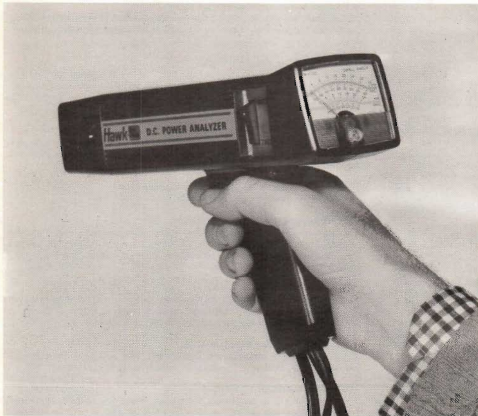
Fig 1. Instrumentet 6010 från Hawk. Detta innehåller såväl stroboskop som kamvinkel- och varvtalsmeter. Pistolutförandet gör att handhavandet blir enkelt. Med instrumentet kan man kontrollera att stroboskopinställningen sker vid rätt varvtal.
