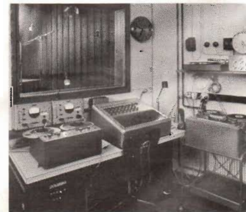
Fig a. Kring den första och ursprungliga mixern, som kom att tjäna skiftande verksamhet i mer än tio år, byggdes företaget upp. Här en interiör från slutet av 1960-talet, då man byggt upp en talstudio och "tog" musik externt mest. Många Revox, en Telefunken M 10, en Studer A 62 m fl bestod "tekniken" jämte mixern etc.
