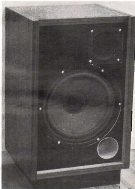
Fig 3. Fronten är här avtagen för att elementens placering och utseende skall framgå. Lägga märke till diskanthornet överst till höger och under denna, tunnelns mynning.
