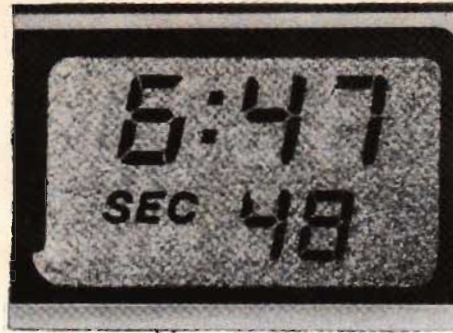
Fig 8. Med LCD-teknik kan man lätt förmedla olika slags "budskap" via urtavlan. Denna urtavla från Beckman talar om vad den visar utöver timmar och minuter.
