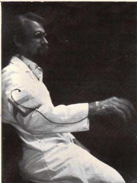
Fig 2. Accelerationsgivaren placeras på lillfinger- sidan av handryggen och har förbindelse till huvudenheten, vilken del fästs till överarmen.
