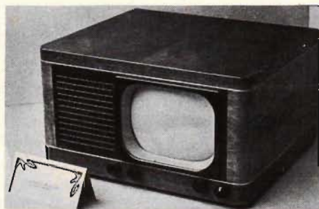
Fig 3. TV-mottagare från 1938, uppbyggd enligt moderna principer med katodstrålerör.
