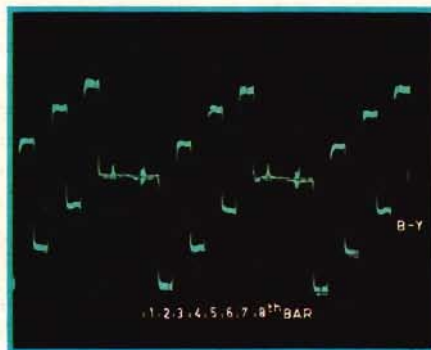
Fig 18. Oscilloskopet visar här den signal som ger bilden i fig 17.
