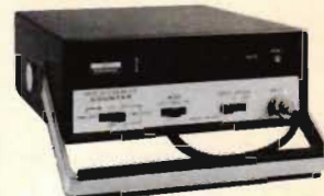
IM-4100 RÄKNARE Frekvens 5 Hz-30 MHz Periodtid 1 \mu s-99999 s Pulsättning 1-99999 Känslighet 15 mV över 50 Hz För nätanslutning eller 12 VDC Pris: 1.088:— exkl moms Byggsats 676:— exkl moms
