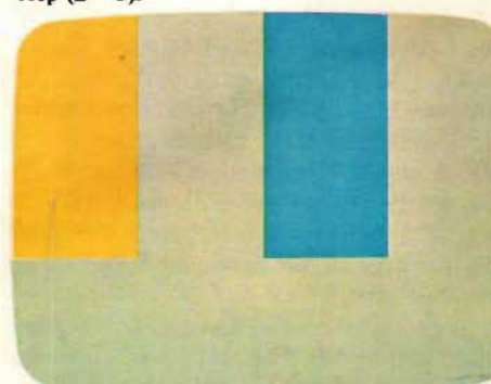
Fig 13. Vid 90° fäsfel ser man att ett färgfält har tillkommit.
