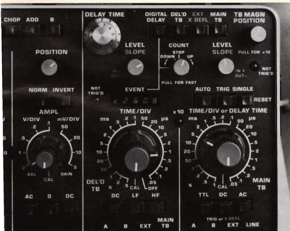
Fig 3. PM 3261 har två tidbasenheter där digitalt fördröjning kan kopplas in på den ena. Den lilla sifferindikatorn i bildens mitt talar om vilken puls i dataflödet som visas på skärmen. Den digitalt fördröjda tidbasenheten tillåter jitter som är större än en period.
