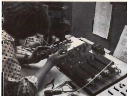
Fig 2. Avsnyning av ett kretskort. De fyra boxarna till höger innehåller servomotorer för automatisk test av potentiometrar i förstärkare.
