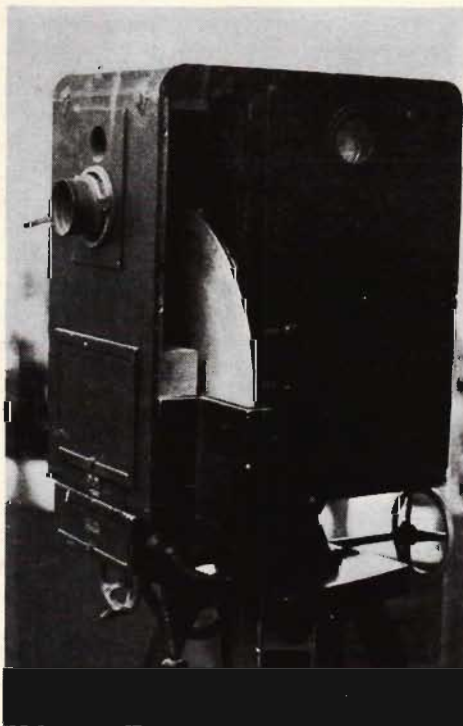
Fig 2. TV-kamera från 1936 med Nipkowskiva och 180 linjers upplösning.
