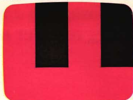
Fig 19. När (R-Y)-signalen kontrolleras är bara den röda kanonen inkopplad. Ingen skillnad skall finnas i ljusstyrka mellan balkarna ett-två, fem-sex och referensbalken. Övriga balkar är svarta.
