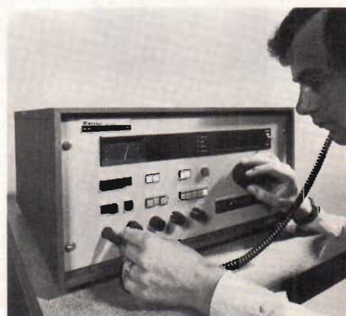
Fig 3. Den nya mottagaren H2540 från Marconi har som option 1 Hz upplösning hos den inbyggda syntesgeneratorm.
