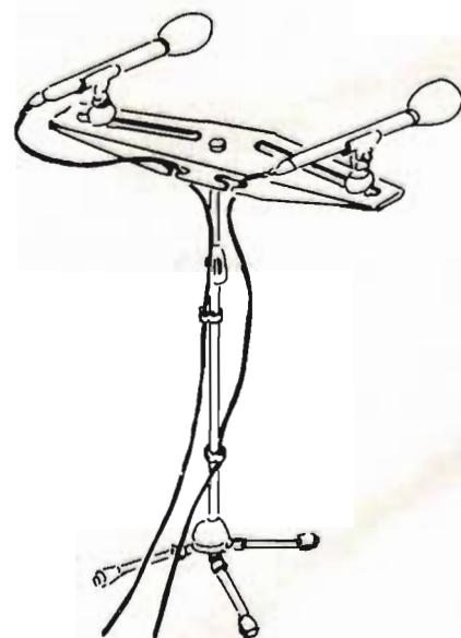
Fig 16. För stereofoniuptagning med två mikrofoner tillgår man montagebäraren TL-E36 enligt ill.
