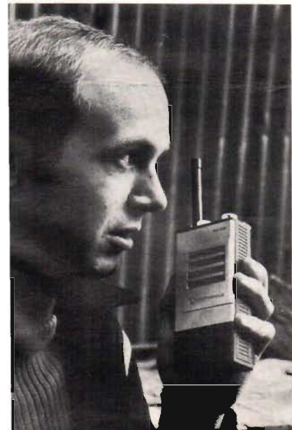
Fig 9 a. Den minsta tranceivern i Motorolas nya serie MX300 . b) MX300 kan skjutas in i en konsol vid bilbruk och ger då 12 W LF-utseffekt.
