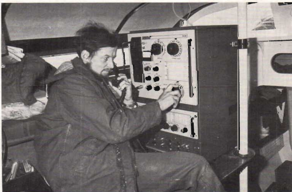
Fig 17. Den nya marina radiostationen TRA952 i sin rätta miljö. Racal tillverkar denna SSB-station som ger 400 W över 1,6 MHz till 22 MHz.
