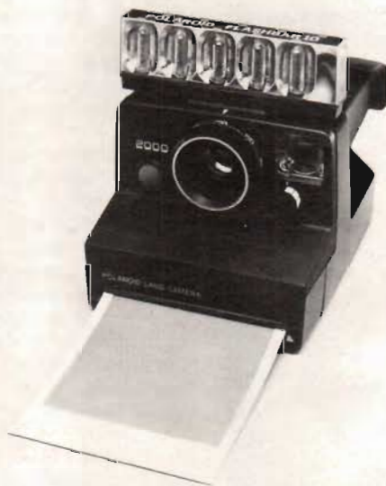
Fig 2. Modell 2000 med påsatt blyxtskena. Filmen ligger vinkelrätt mot objektivet strålgång, och bilden projiceras på filmen med en spegel i kamerahusets baksida.
