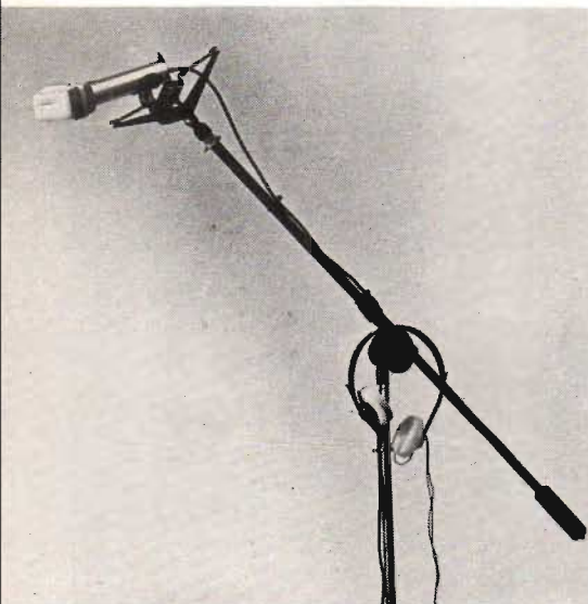
Fig 10. Här överdelen av huvudstativet med vanlig mikrofonbom apterad plus vibrationselastisk korg som här bär upp stereomikrofonsystemet. Inom parentes: Vissa av JVC:s och Technics nya mikrofoner är fynd för popbruk och har visat sig ha god användbarhet i studiosammanhangen, enligt bl a rön som Decibel i Stockholm kunnat göra.
