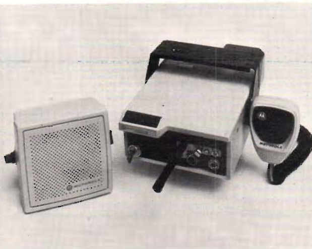
Fig 9 a. Den minsta tranceivern i Motorolas nya serie MX300 . b) MX300 kan skjutas in i en konsol vid bilbruk och ger då 12 W LF-utseffekt.
