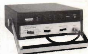
IM-4100 RÄKNARE Frekvens 5 Hz-30 MHz Periodtid 1 \mu s-99999 s Pulsmätning 1-99999 Känslighet 15 mV över 50 Hz För nätanslutning eller 12 VDC Pris: 1.088:— exkl moms Byggsats 676:— exkl moms
