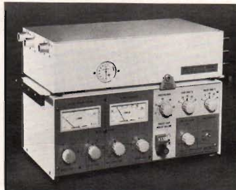
Fig 1. Servoverntilator 900. Övre sektionen innehåller den pneumatiska (pneumatiska) delen, medan elektroniken finns i den nedre delen. Visarinstrumenten anger dels utandningsvolym (t v) dels trycket i luftvägarna (t h).
