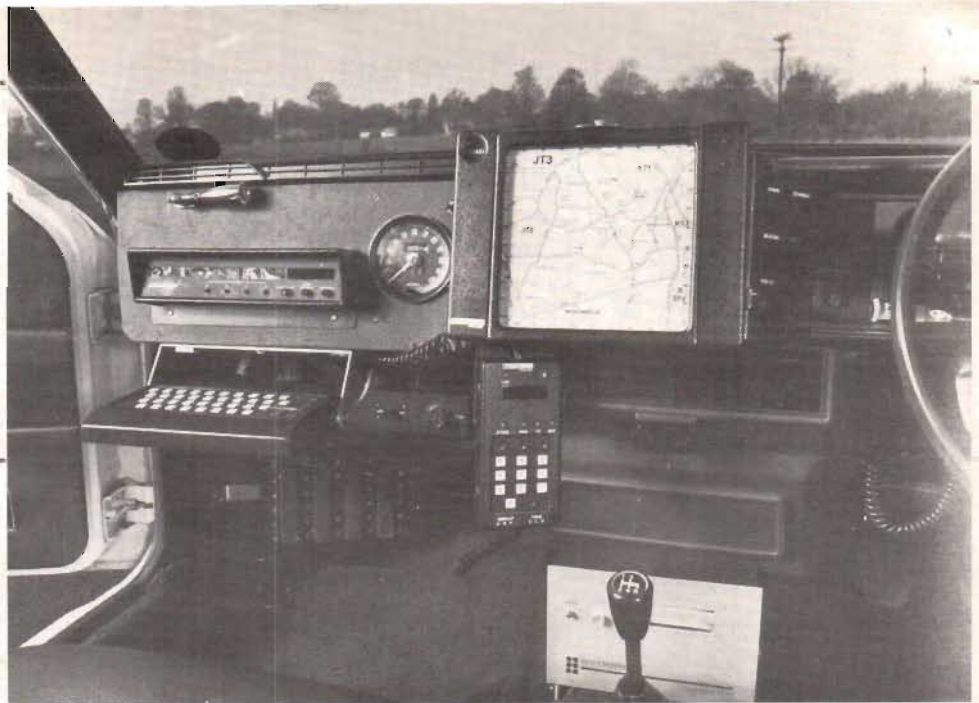
Fig 8. Här visas en typisk installation i en polisbil av det dataterminalsystem, typ MADE , som Marconi tagit fram.
