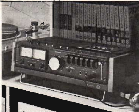
Fig 8. Här ses "vaggan" eller höljet för 1636, ett nytt tillbehör för den stationära användningen av däckat.
