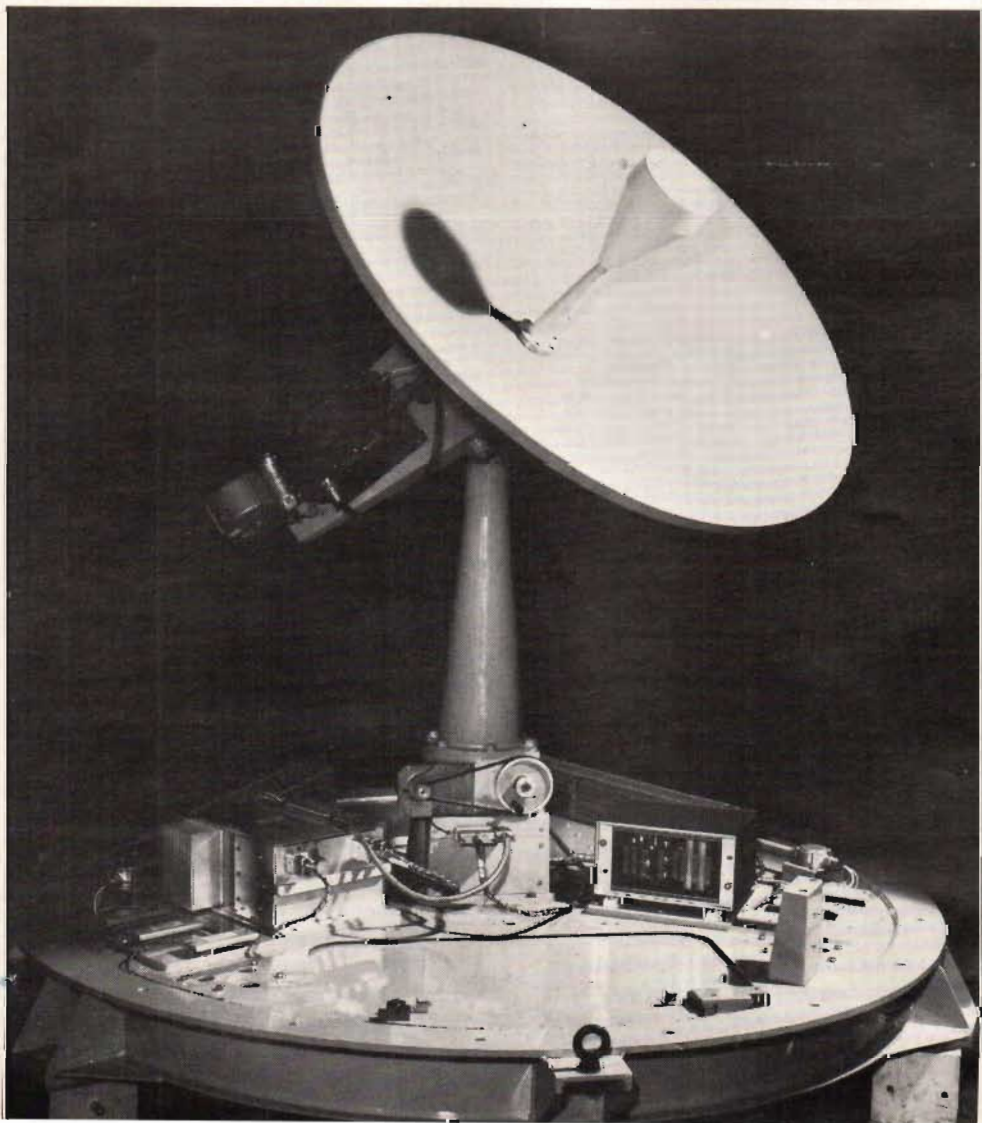
Fig 7. Bilden visar Englands första tillverkade satellitterminal för marint bruk. Arion heter terminalen som tillverkas av Marconi.
