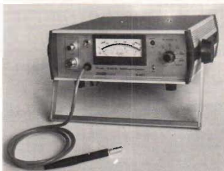
Fig 16. Bilden visar den nya millivoltmätaren 9301 från Racal, vilken medger mätningar upp till 1,5 GHz.
