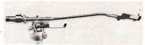
Fig 10. Den i extremt lätta material utförda 40 cm tonarmen för kondensatorpick up (här med vanligt p u-skal). Tala om precision — vinkelfelet garanteras hållas ej högre än 0,08°! Rotationsfriktion högst 5 mg, överhäng 12 mm, total längd 420 mm, effektiv längd 312 mm. Lagren är specialgjorda och sitter i dubbla upplagor i fundament etc. Stax har använt "ultrasensitiva" urverksdiamanter ihop med stabiliserande "flytande" upphängda kullagerkransar för eliminering av axialvinkelfel. Polering och precision till högsta industristandard. Tonarmsnedlägget är oljedämpat. Kablaget är av lågkapacitivtyp.
