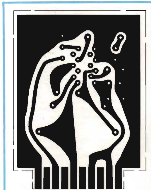
Fig 2. Mönsterkort i skala 1:1 för LF-förstärkaren.
