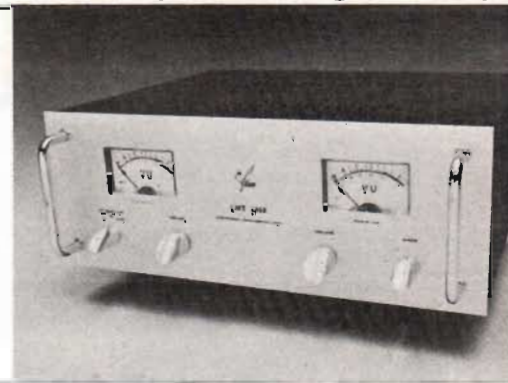
Fig 11. En av ASD:s största förstärkare, försteget ASD 410 som har en klass A-förstärkare i sig för hörtelefondrift. Man får 4-kanalmöjlighet och har sex dubblade ingångar jämte bandkopiering etc. Den kostar ca 7 000 kr i Frankrike.
