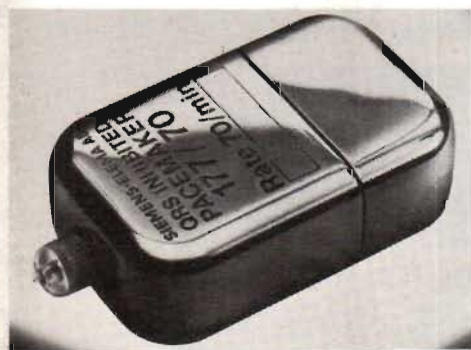
Fig 4. En modern pacemaker i metallhylsa, vilken tjänar som indifferent elektrod och samtidigt skärmar mot störningar.
