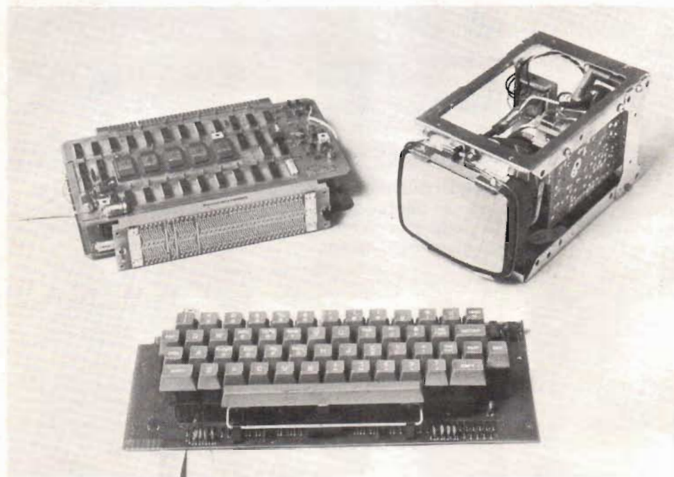
Fig 3. AMI:s mindre utvecklingssystem EVK 300 kan levereras i attachéväska inkluderande nätdel.
