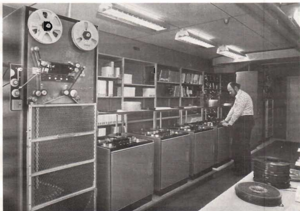
I kassettfabriken är automatiseringen av kassettkopiering långt driven. Två program kan köras samtidigt och kopieras på en eller flera kopieringsmaskiner. Roland Skärlund leder arbetet på kassettfabriken.
