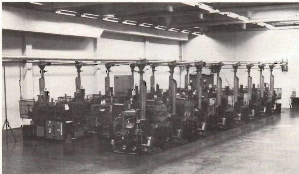
I presshallen finns 16 pressar för LP-skivor och två för singleskivor. Produktionskapaciteten är för närvarande ca sex miljoner skivor om året. Det finns möjlighet att bygga ut kapaciteten till 13 miljoner LP-skivor per år med totalt 42 LP-pressar.
