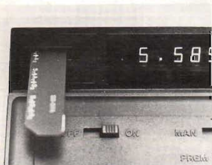
Fig 2. Vid programladdning förs magnetkortet in i springan bredvid sifferfönstret. En motor aktiveras då och drar in kortet.
