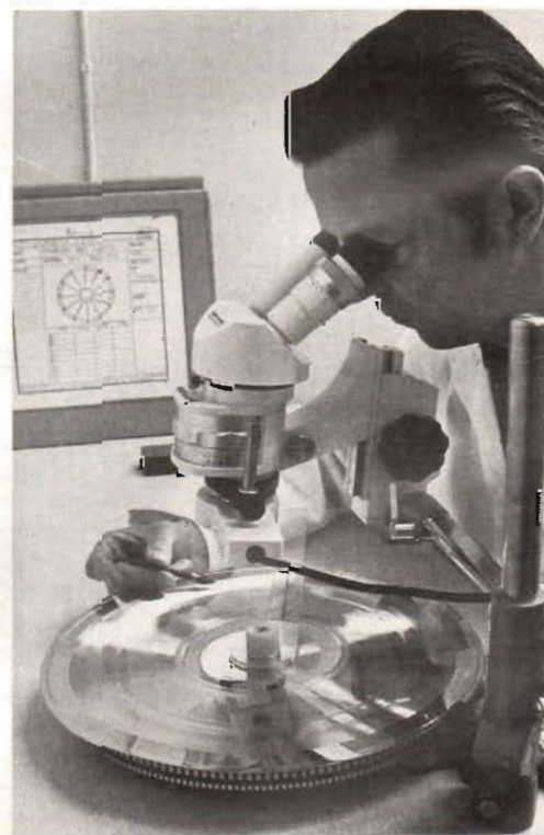
Ett av de viktigaste momenten vid framställningen av skivor och kassetter i Åmål är kvalitetskontrollen. Denna sker även i tidiga led av produktionen. Här kontrollerar Ole Jensen matriser före pressningen.
