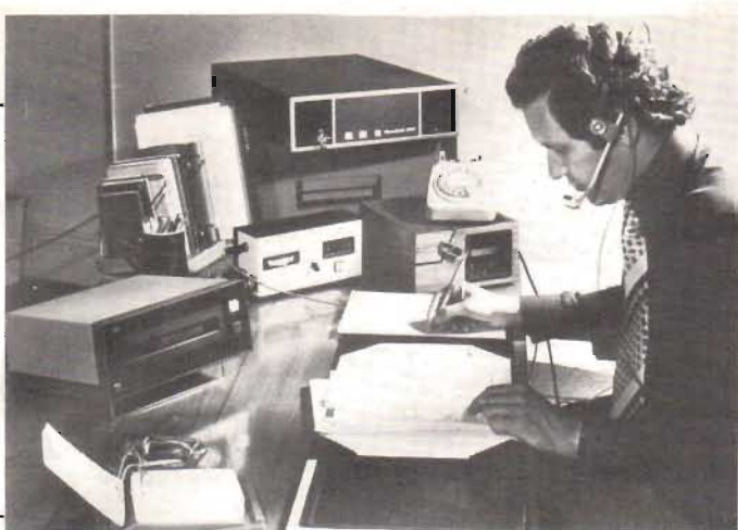
Fig 1. Den röststyrda dataterminalen i arbete. Framför operatören sitter här en alfnumerisk skärm som talar om hur maskinen har tolkat hans indata.
