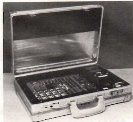
Fig 3. AMI:s mindre utvecklingssystem EVK 300 kan levereras i attachéväska inkluderande nätdel.
